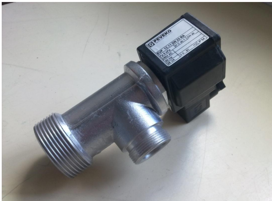
Obrázek 9 Elektromag. ventil EVF 12.11 DN 25 RA (vlastní zpracování)
