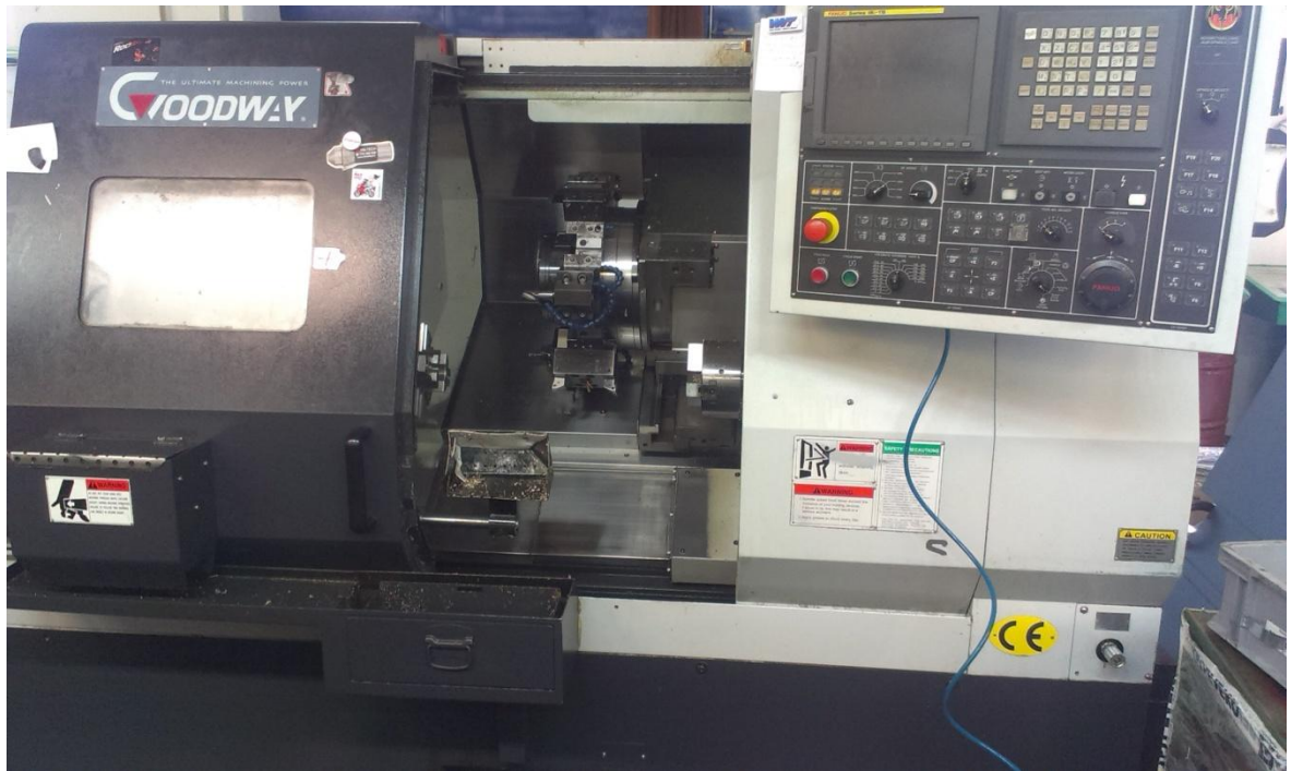
Obrázek 12 NC soustružnické centrum GOODWAY GS 200 (vlastní zpracování)
