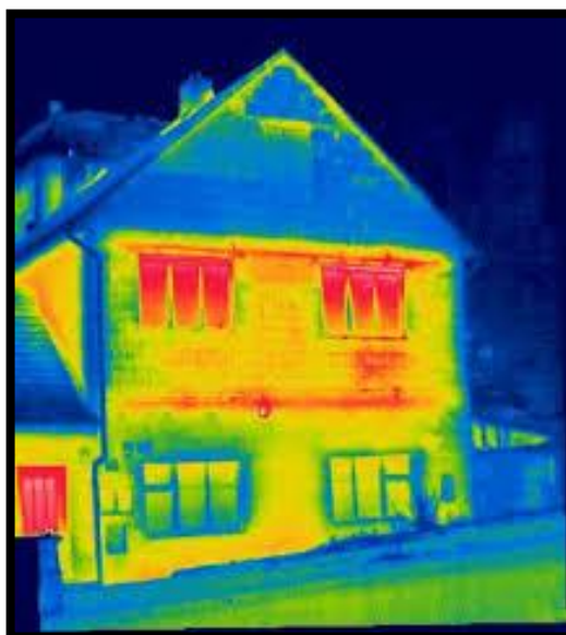
Obr. 22. Únik tepla zachycený termokamerou [36]
