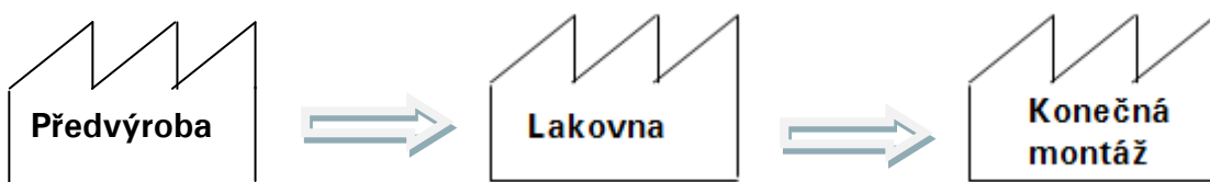
Obr. 31. Schéma materiálového toku výroby sedacích souprav – (vlastní zpracování)
