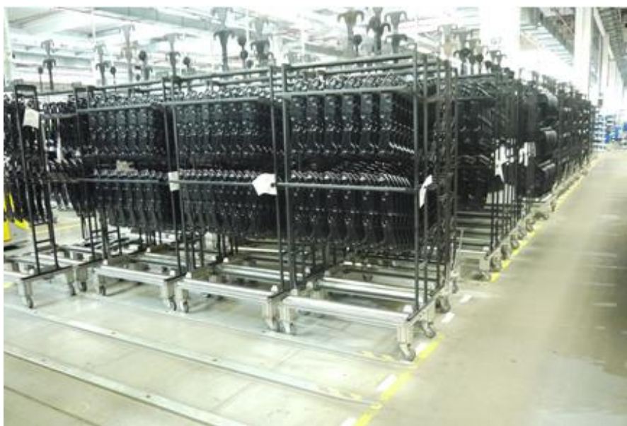
Obr. 38. Zásobník stojanů pro zpracování na konečné montáži. – (vlastní zpracování)
