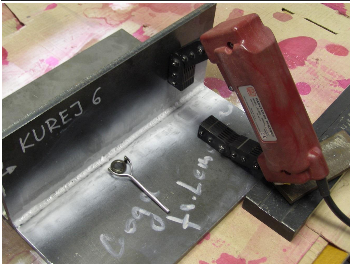
Obr. 5.58 Magnetizace vzorku č. 6
