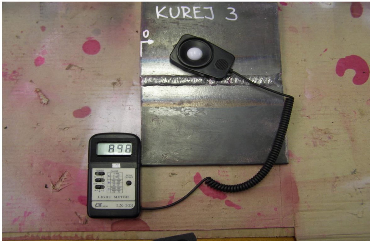
Obr. 5.25 Měření světla, které dopadá na povrch zkoušeného povrchu, světlo musí být min.500luxů.
