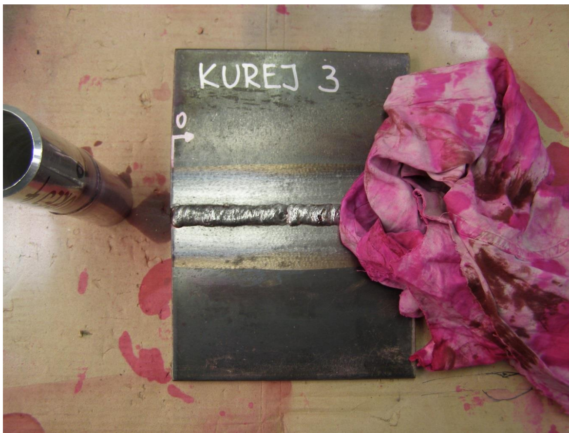
Obr. 5.30 Očištění pentrantu ze zkušebního vzorku tkaninou navlhčenou rozpouštědlem
