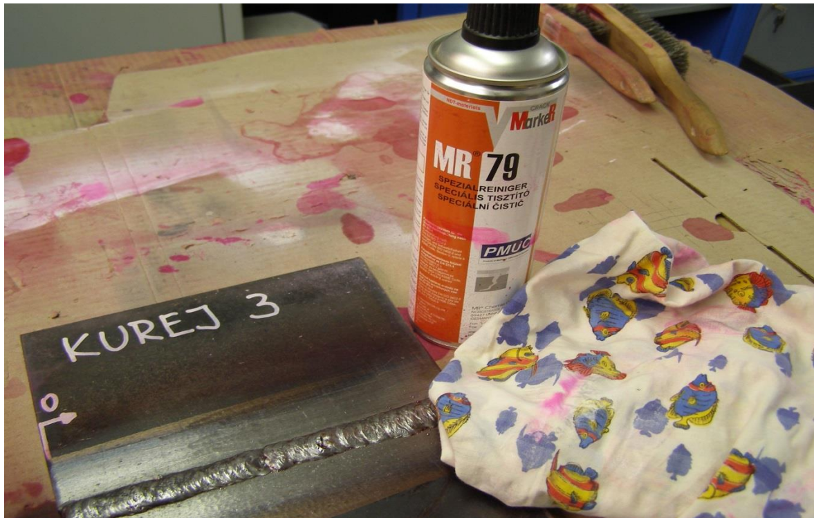
Obr. 5.27 Očištění povrchu zkušebního vzorku před nanesením penetrantu
