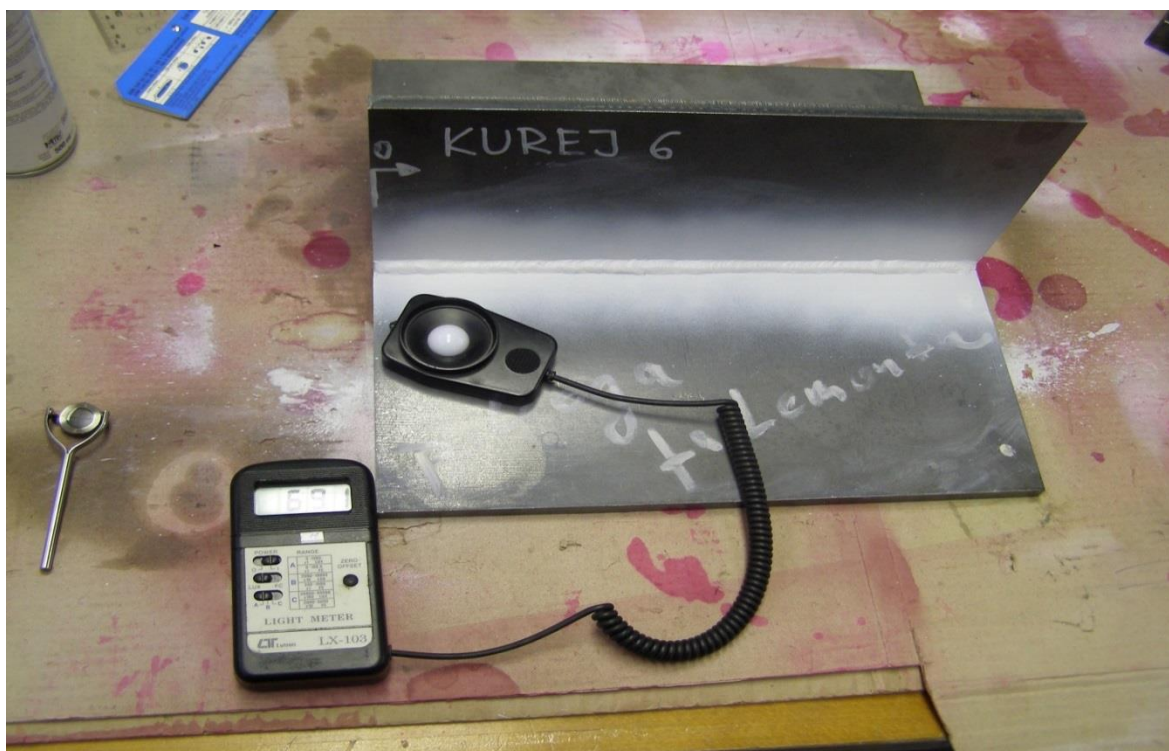
Obr. 5.55 Měření intenzity dopadající na zkoušený povrch
