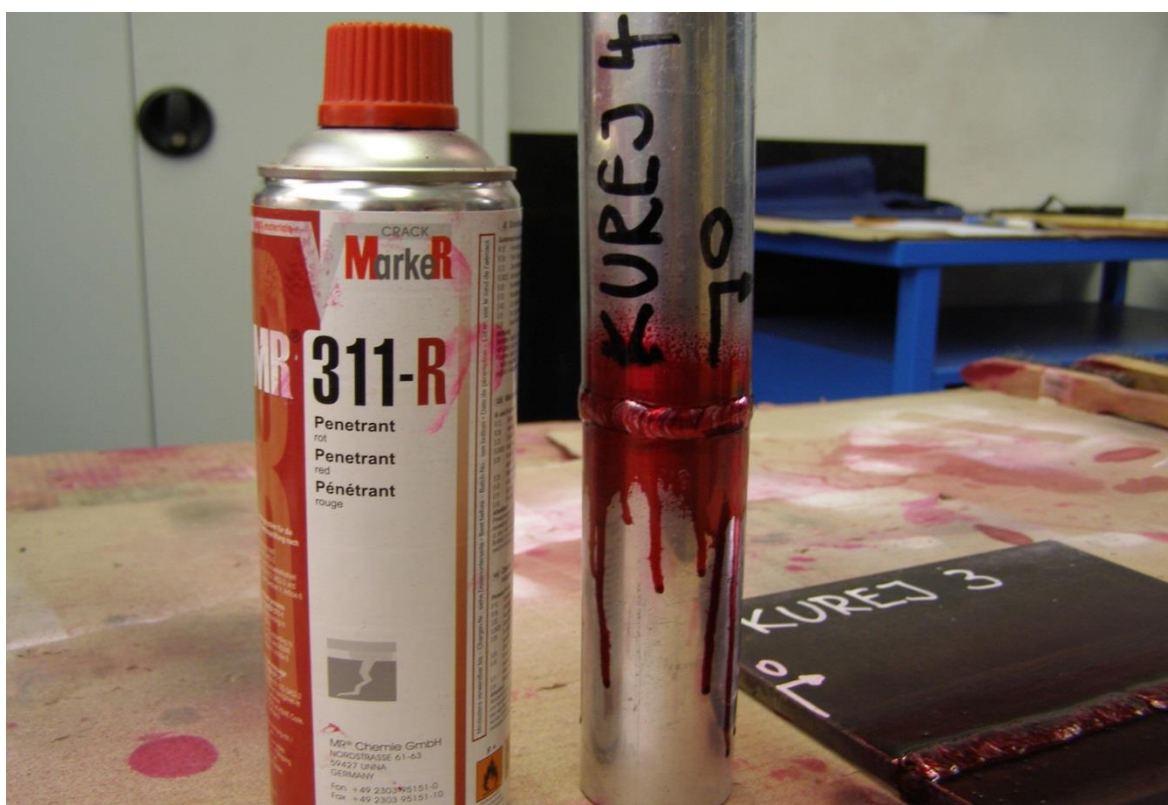
Obr. 5.38 Nanesení penetrantu na zkušební vzorek č. 4. Penetrační čas 15 min
