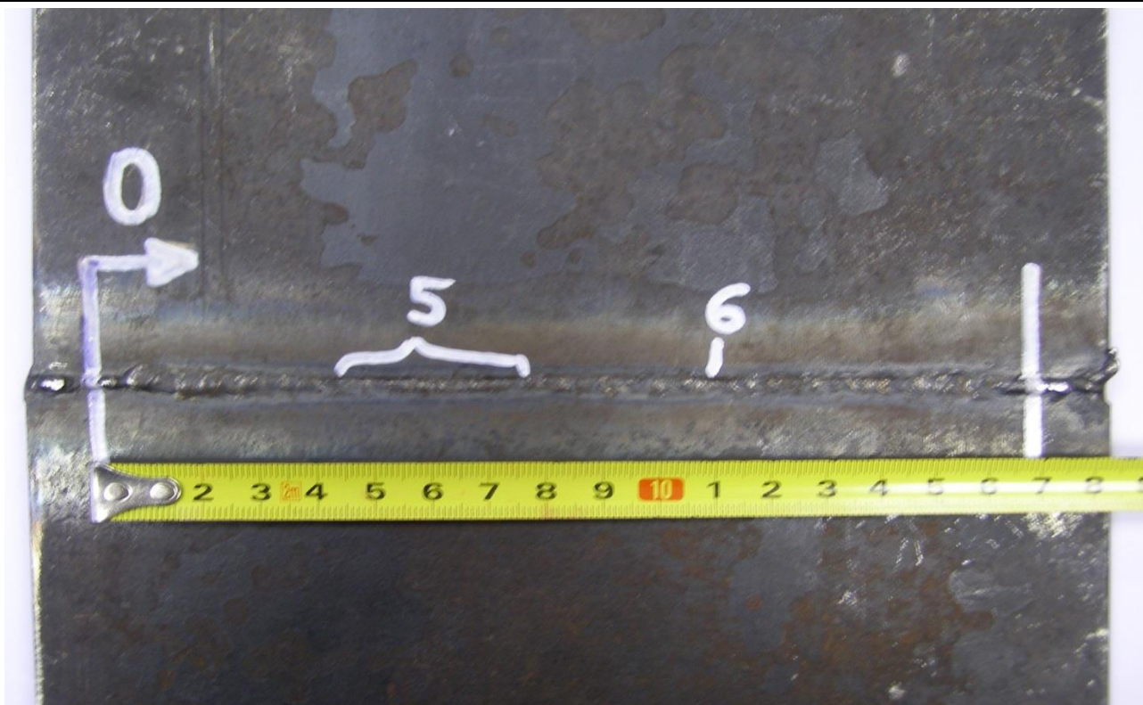
Obr. 5.11 Vizuální kontrola sváru - vyhodnocování a označování vad (kořen sváru)
