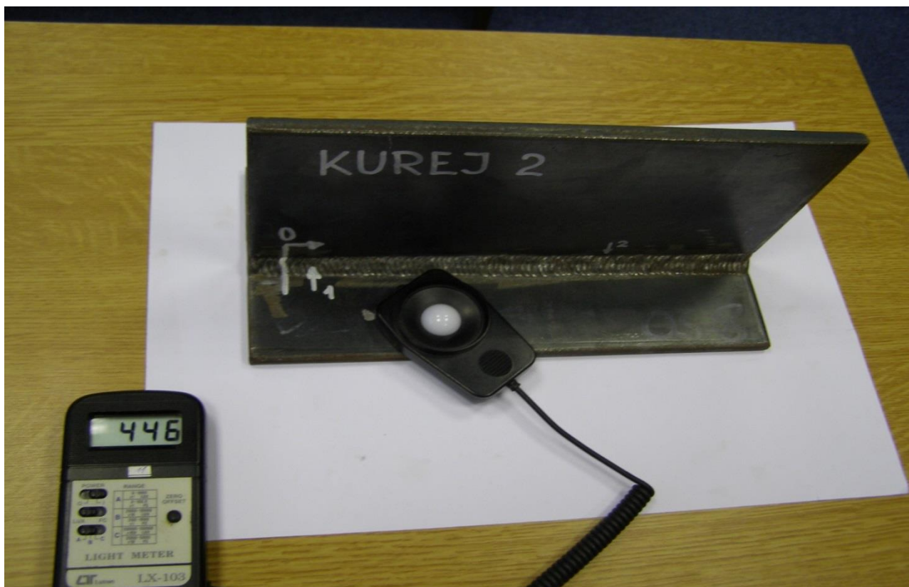
Obr.5.17 Měření světla, které dopadá na povrch zkoušeného povrchu(světlo musí být min.350 luxů)
