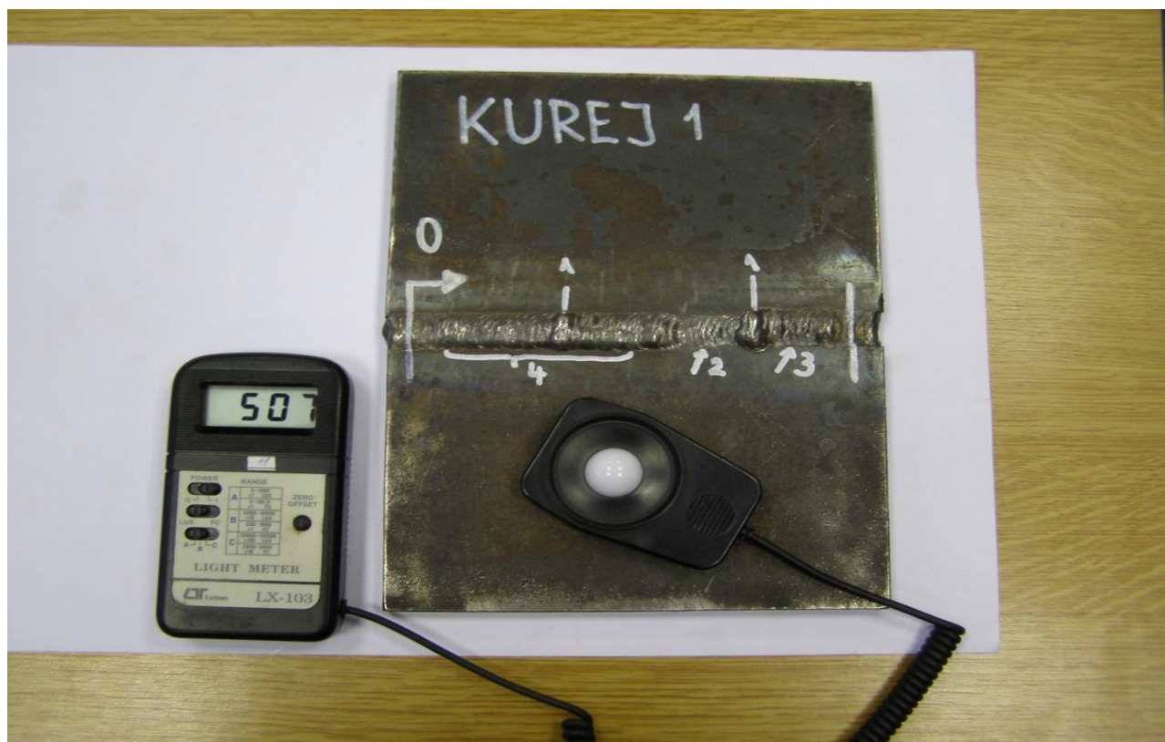
Obr. 5.4 Měření světla, které dopadá na povrch zkoušeného povrchu (světlo musí být min.350 luxů)
