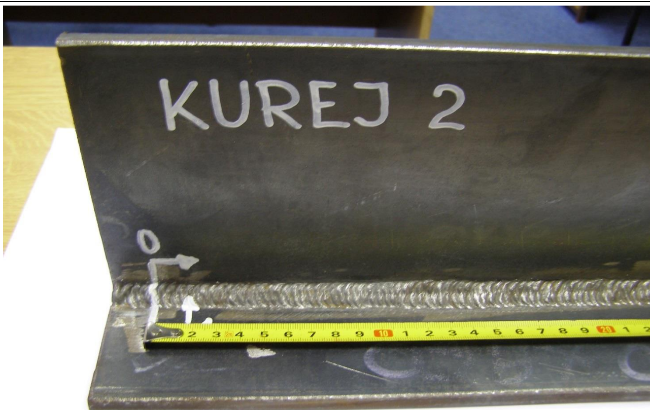
Obr. 5.20 Vizuální kontrola - vyhodnocování a označování vad
