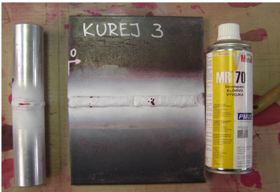
Obr. 5.40 Nanesení vývojky, začátek vyvolávání
