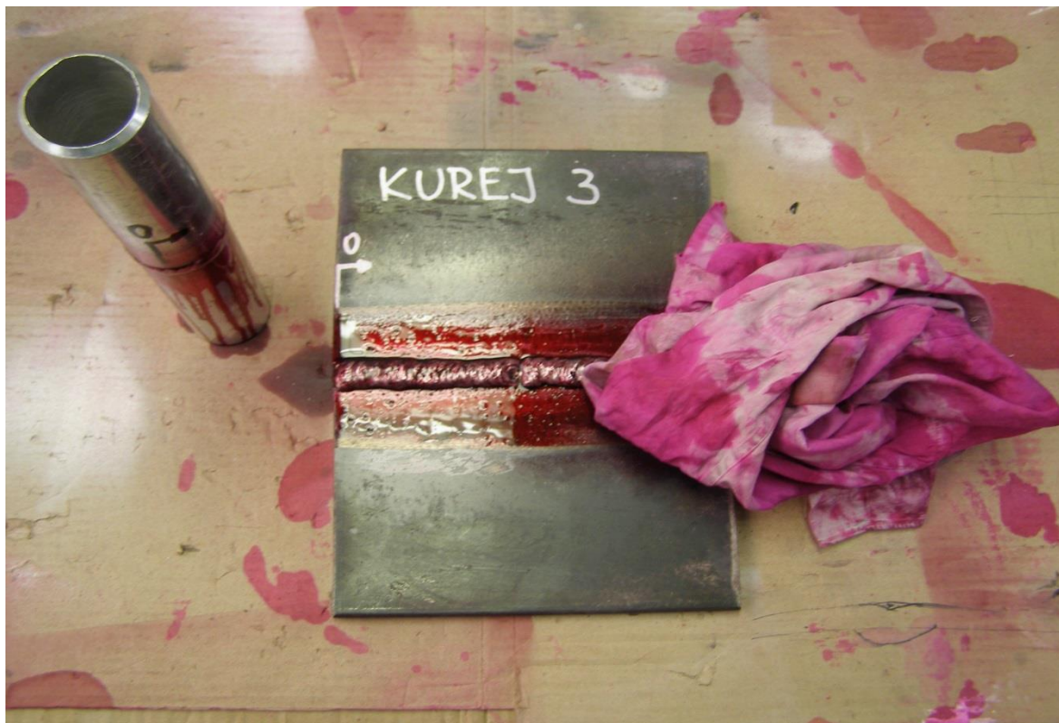
Obr. 5.29 Očištění přebytečného penetrantu, po uplynutí penetračního času
