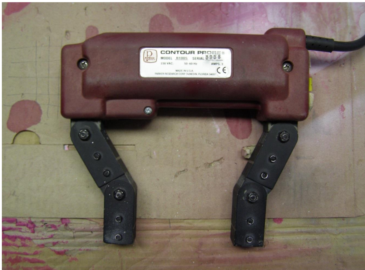
Obr. 5.47 Magnetické Jho – Parker B100S
