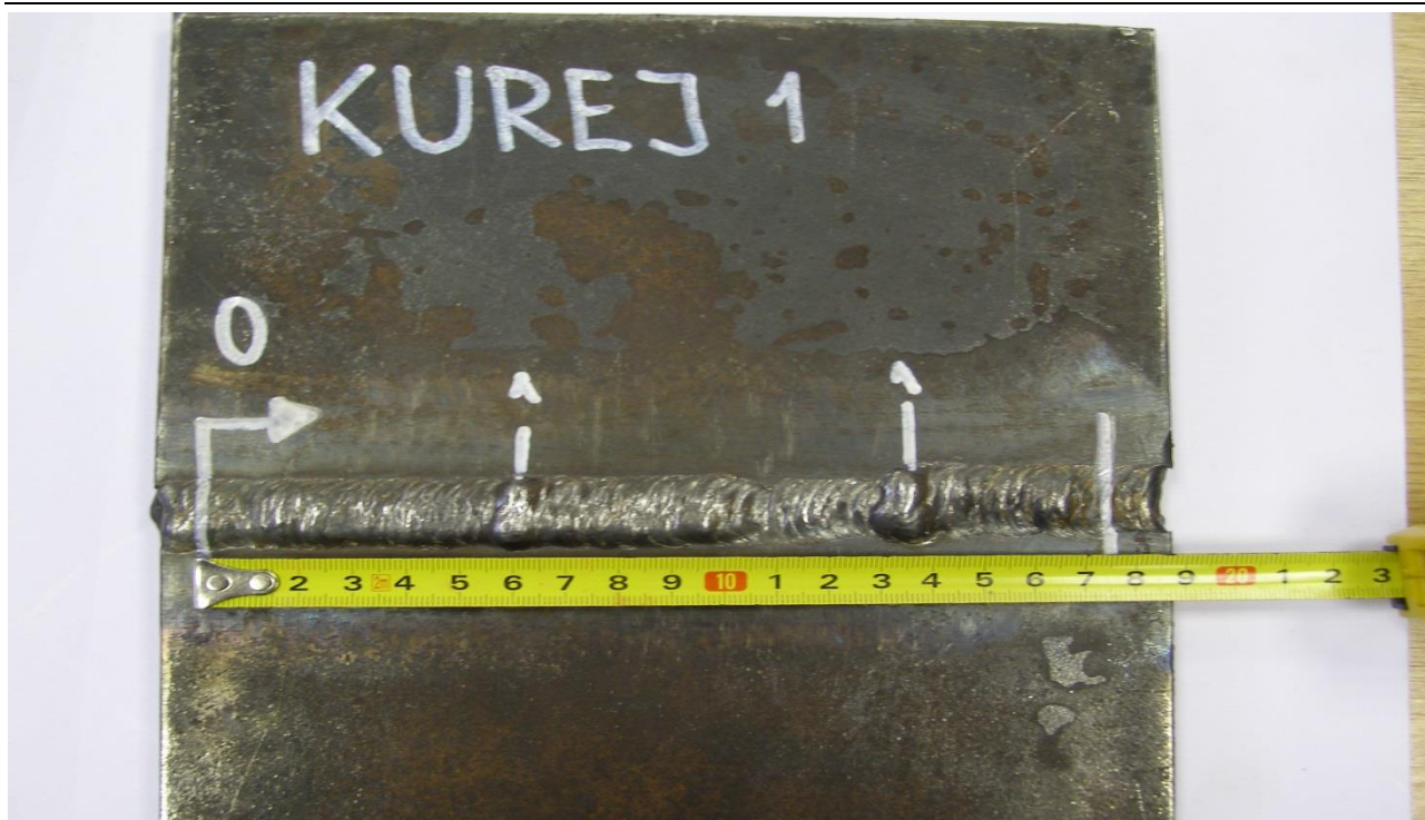
Obr. 5.5 Vizuální kontrola - vyhodnocování a označování vad (povrch sváru)
