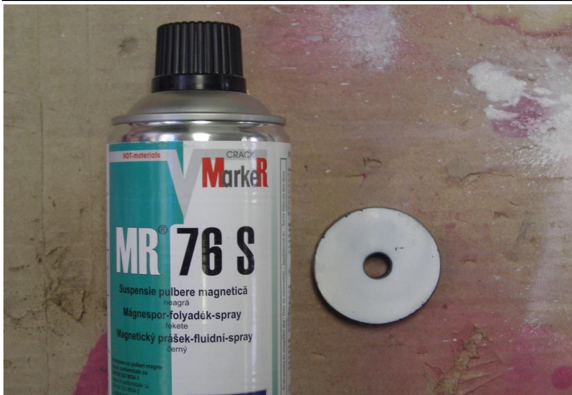
Obr. 5.45 Nanesení magnetického prášku na Měrku MTU č. 3
