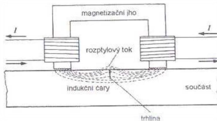
Obr. 2.10 Magnetování magnetizačním jhem [1]
