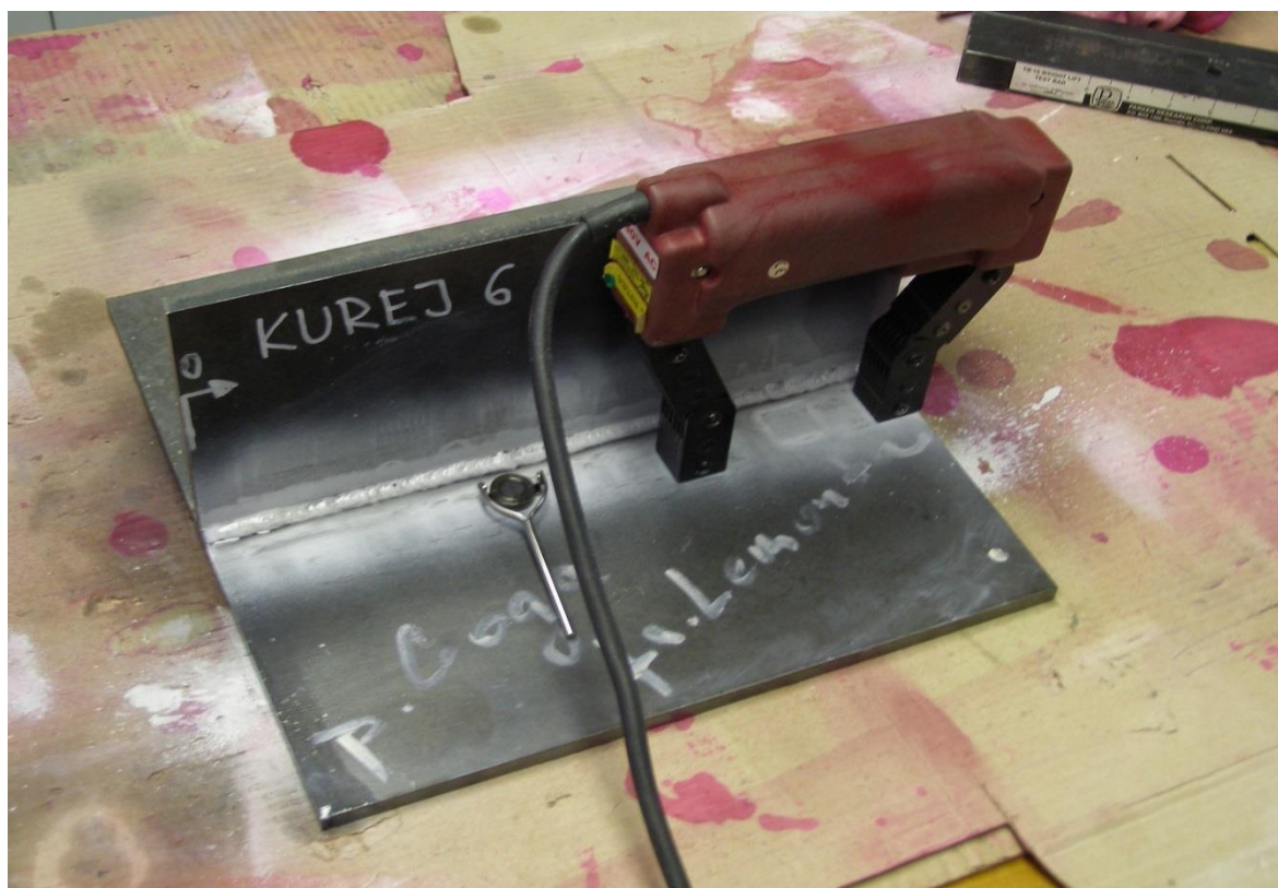
Obr. 5.57 Magnetizace vzorku č. 6
