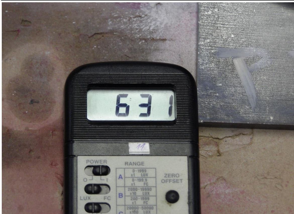
Obr. 5.51 Měření intenzity světla dopadající na zkoušený povrch
