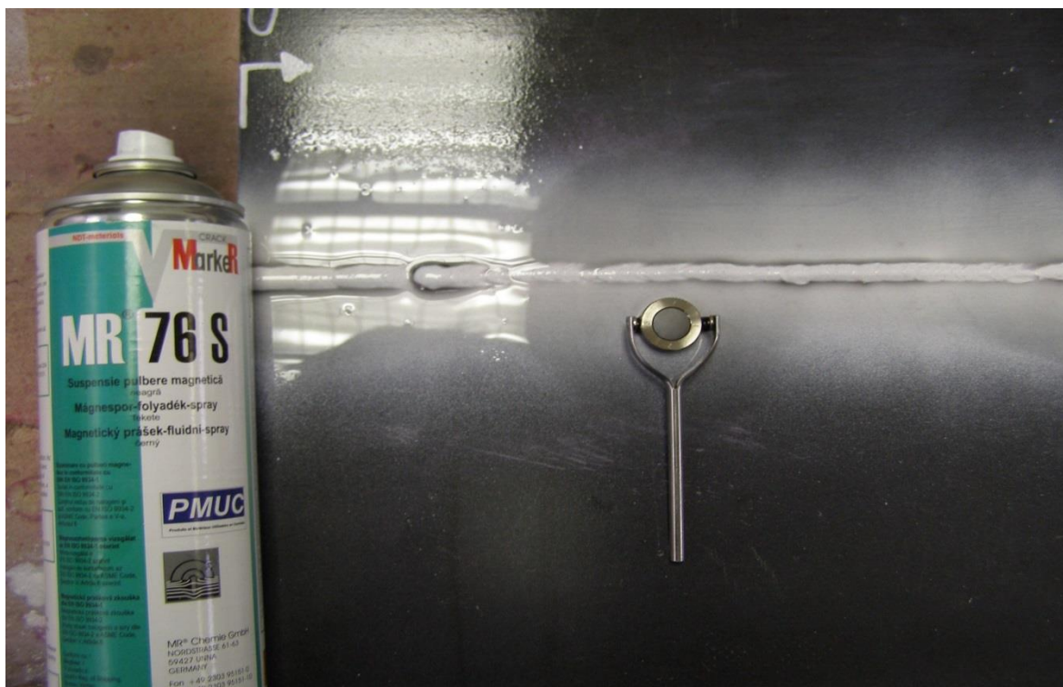
Obr. 5.50 Ověření směru a intenzity magnetického pole pomocí Bertholdové měřky u vzorku číslo 5
