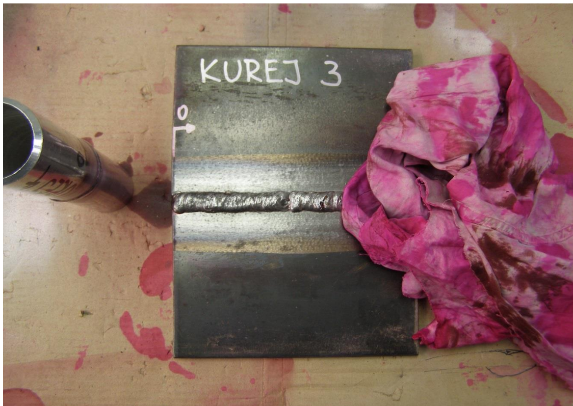
Obr. 5.39 Očištění povrchu zkušební vzorku od penetrantu, ihned po uplynutí penetračního času
