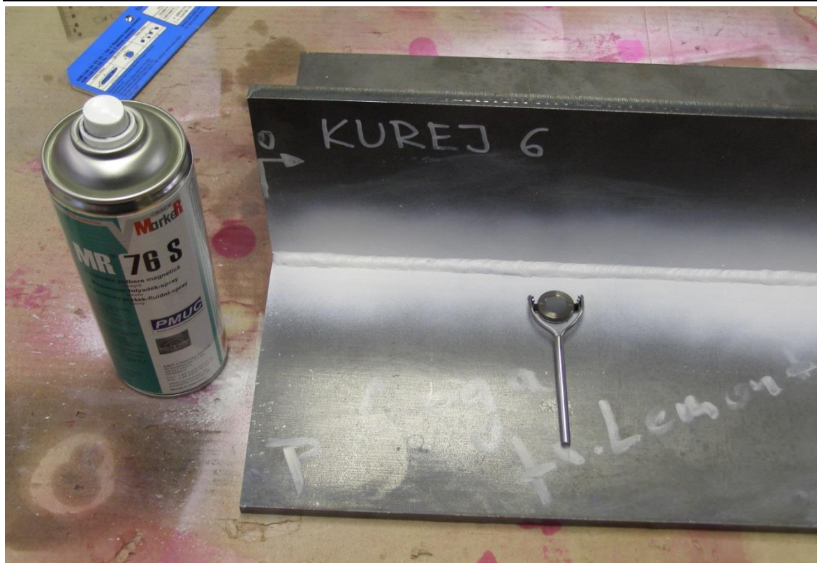
Obr. 5.56 Ověření směru a intenzity magnetického pole pomocí Bertholdové měrky u vzorku číslo 6
