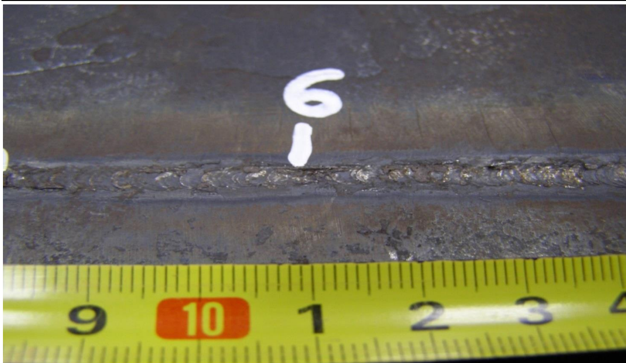
Obr. 5.13 Detail vady sváru – neprovařený kořen
