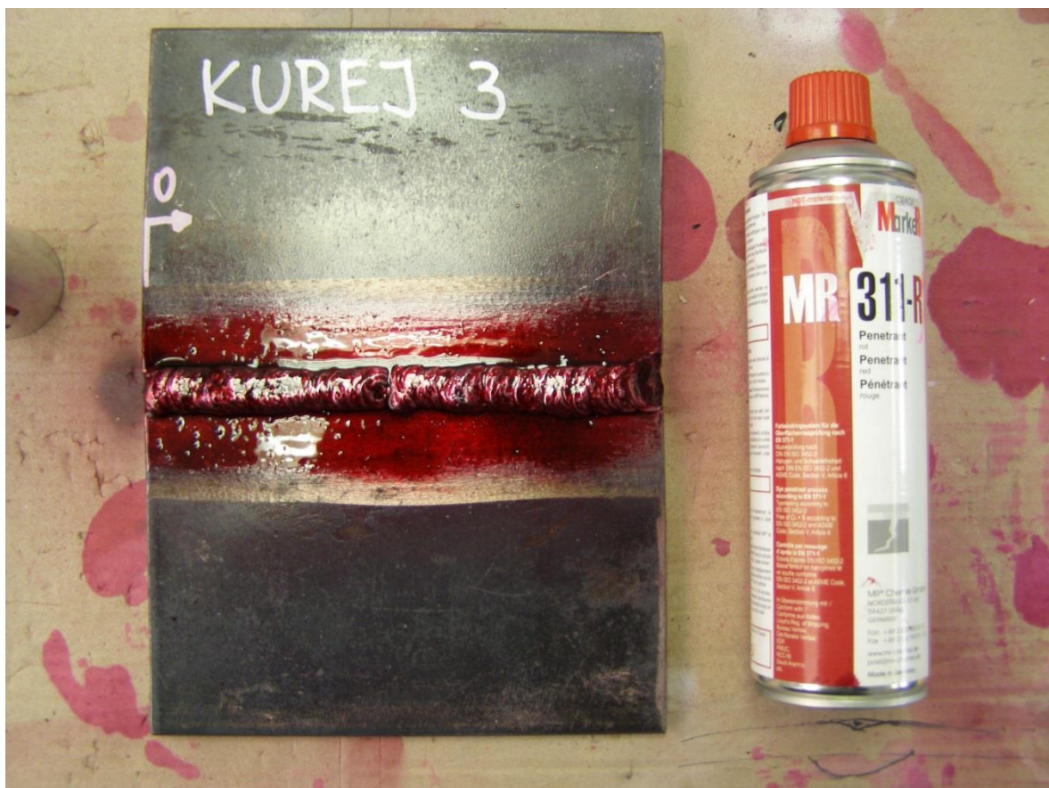
Obr. 5.28 Nanesení penetrantu na zkušební vzorek č. 3. Penetrační čas 15 min
