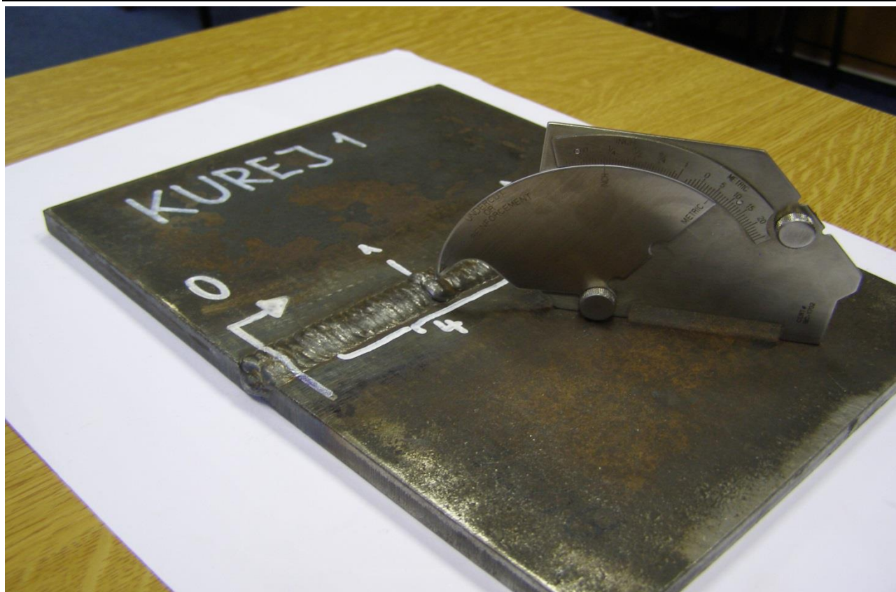
Obr. 5.7 Měření nadměrného převýšení sváru pomoci víceúhelové měřky
