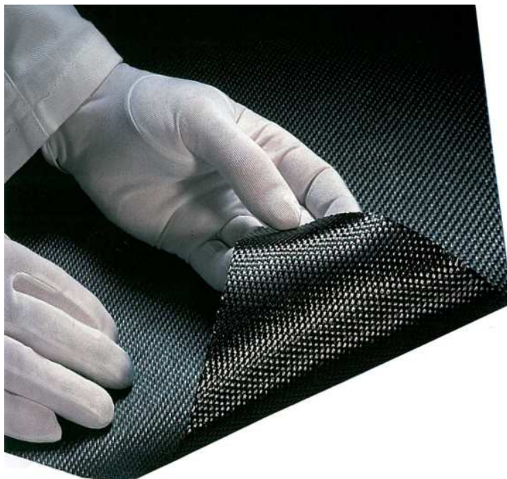
Obr. 4. Prepreg vyrobený z uhlíkových vláken. [20]
