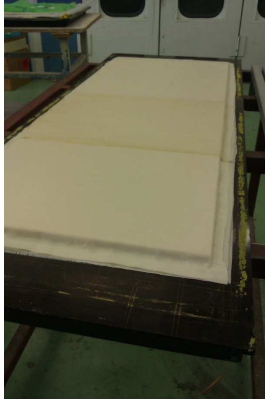
Obr. 45. Sendvičový panel před překrytím odsávací fólií.
