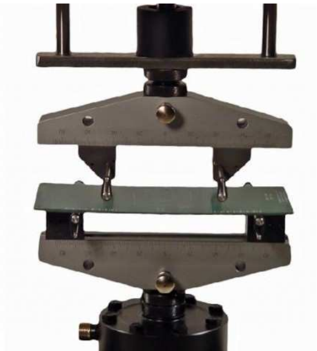
Obr. 31. Schéma zkoušky na čtyřbodový ohyb. [33]
