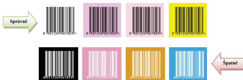
Obr. 58. Barevné kombinace čárových kódů (Gs1, © 2014)
