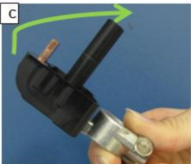
Obr. 48 Pracovní postup kontroly a dorovnání pozice pinů (interní dokumentace firmy XY)
