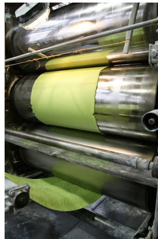
Obr. č. 13 válcování EVAC, (vlastní zdroj, 2015)
