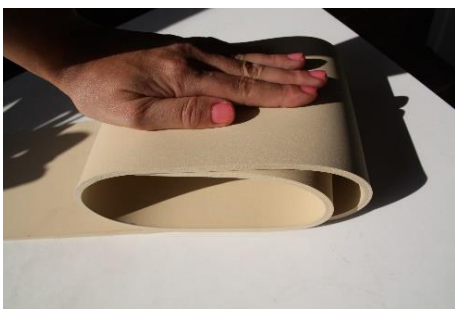
Obr. č. 29 materiálové zkoušky - ohýbání Evacu (Zdroj: vlastní, 2015)
