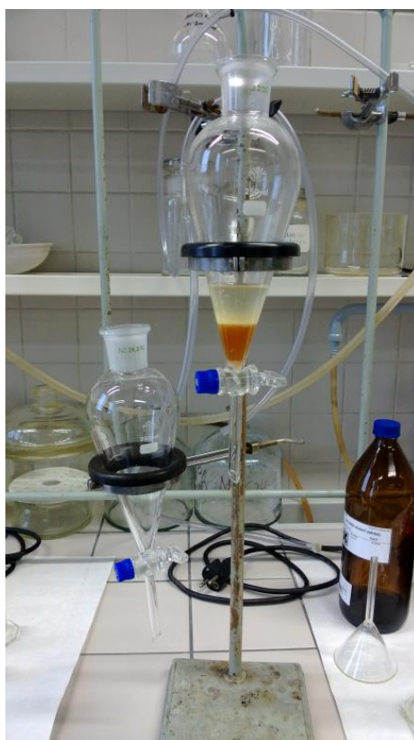
Obr. 20. Dělení vodné a heptanové fáze
