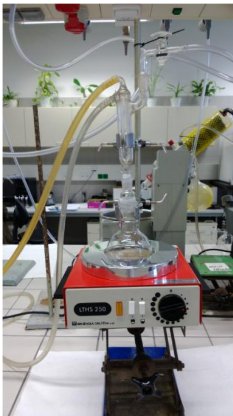
Obr. 19. Aparatura na přípravu metylesterů
