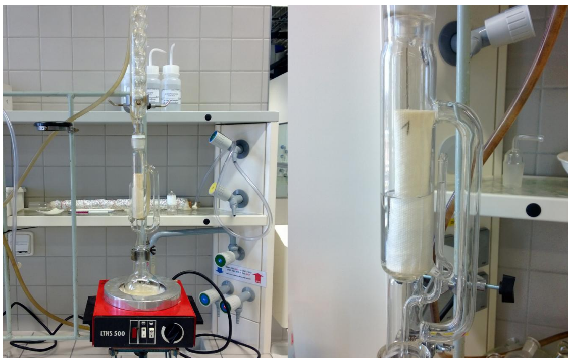
Obr. 16. Aparatura pro Soxhletovu extrakci
