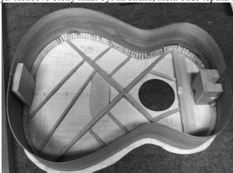
Obr.13 – Luby s obvodovou výložkou slepené k přední desce
