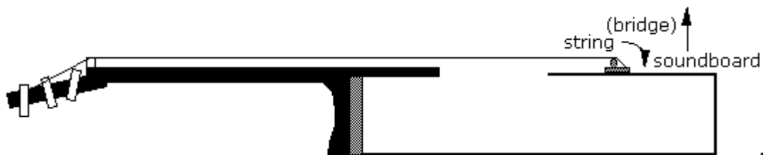
Obr.7 – Resonance vysokých frekvencí akustické kytary
