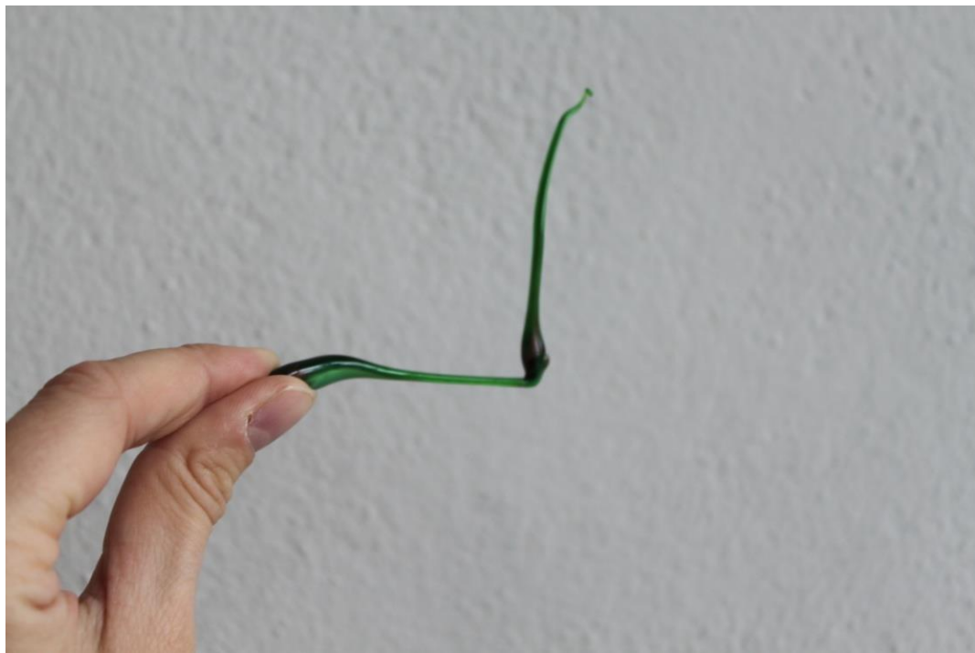
Obr. 30 Zkouška nožičky tvarováním skla nad kahanem
