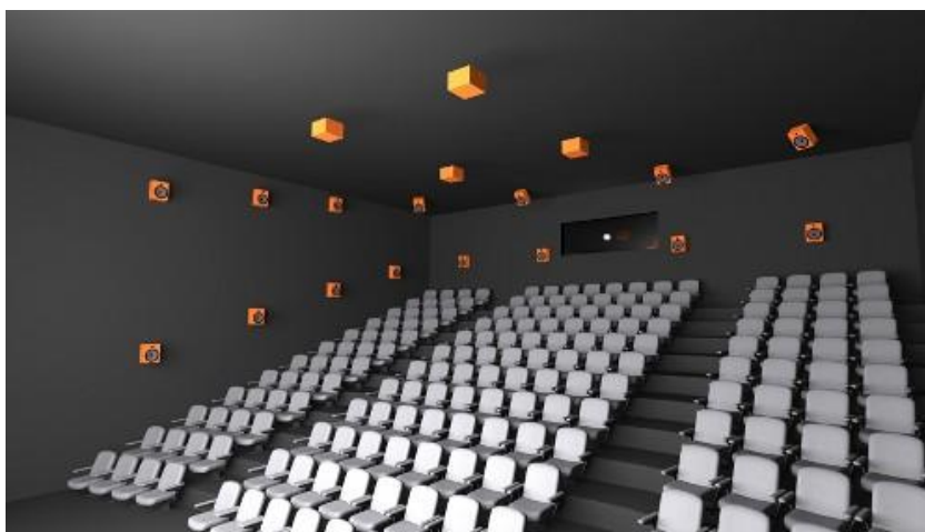
Obr. 11. Schéma reprosoustav v sále u systému Barco Auro 11.1.
