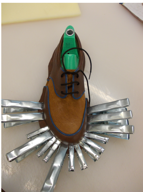
Obr. 38: Napínání svršku pomocí svorek.
