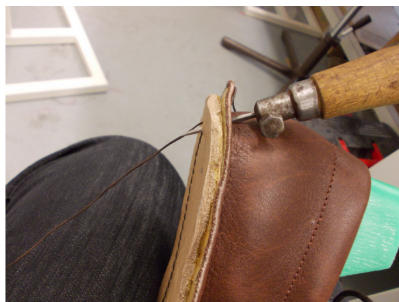
Obr. 39: Ruční prošívání svršku ke stélce.
