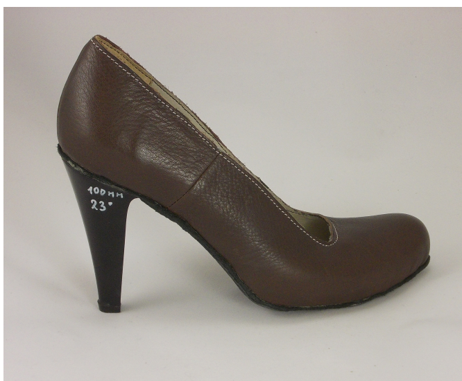
Obr. 25: Zkušební lodička bez klenku.
