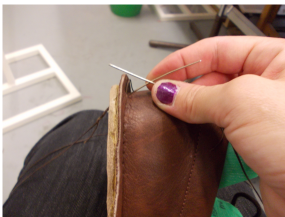
Obr. 40: Ruční prošívání svršku ke stélce.
