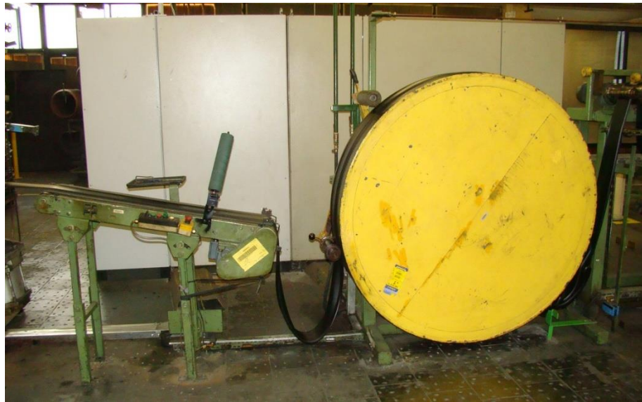
Obr. 13. Odťahový dopravník a chladiaci bubon (vlastné spracovanie)
