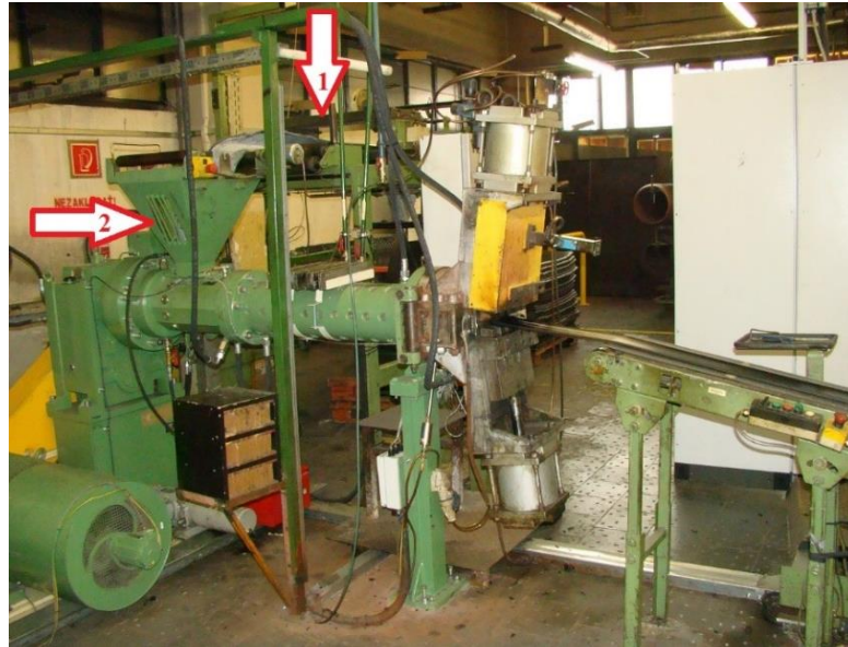
Obr. 11. Časti linky: 1 – detektor kovov, 2 – extrúder (vlastné spracovanie)
