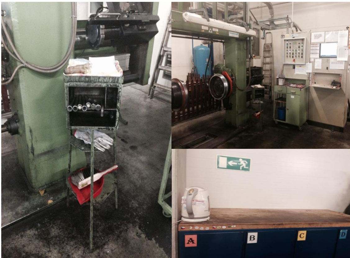
Obr.45. Stav na pracovišti po aplikaci metody 5S (vlastní zpracování)
