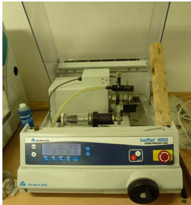
Obr. 36 Řezání vzorků na přístroji Buehler Isomet 4000
