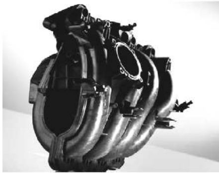
Obr. 22 Příklad aplikace PP+GF- sací potrubí VW [27]
