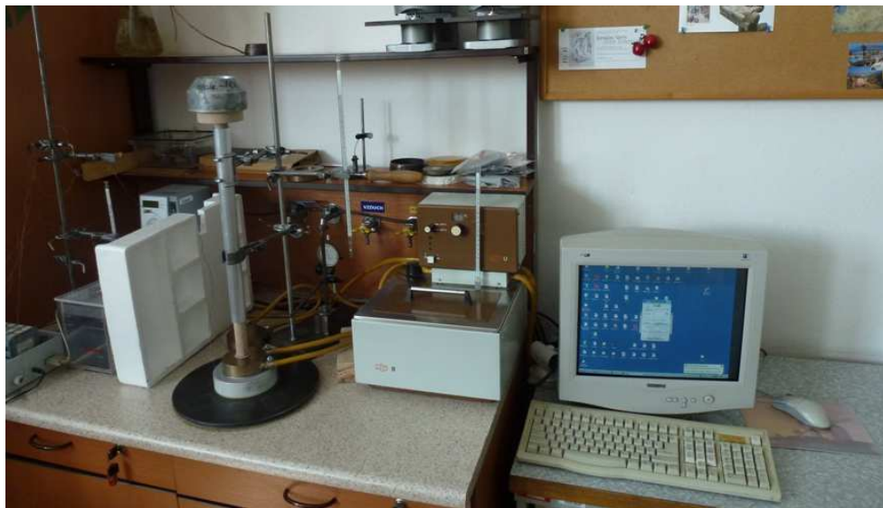
Obr. 42 Měření tepelné vodivosti na Fitchově přístroji
