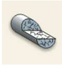
Obr. 12 Tvar granulátu plněného krátkým vláknem [10]
