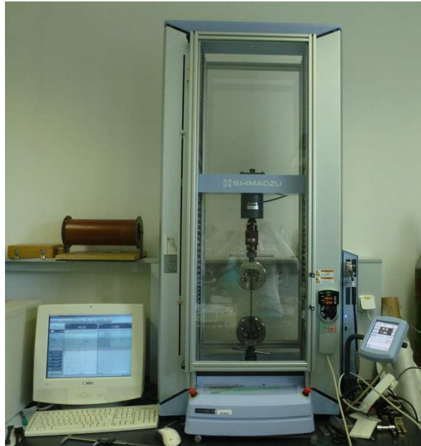
Obr. 39 Zařízení pro tahovou zkoušku – Shimadzu
