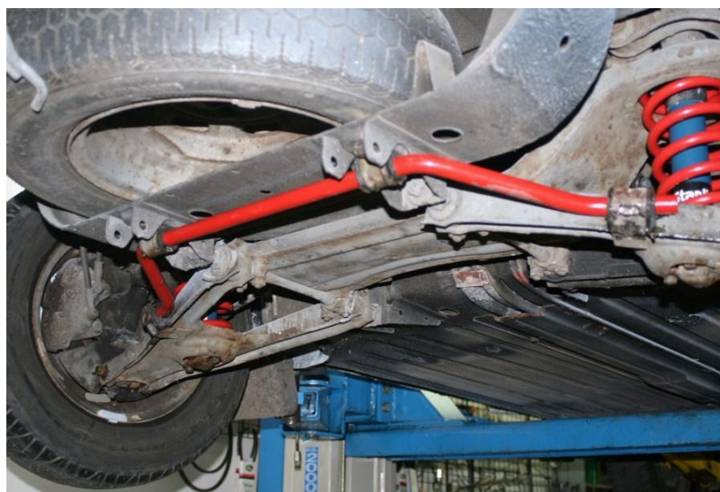
Obrázek 8 – Stabilizátor instalovaný na podvozku auta
