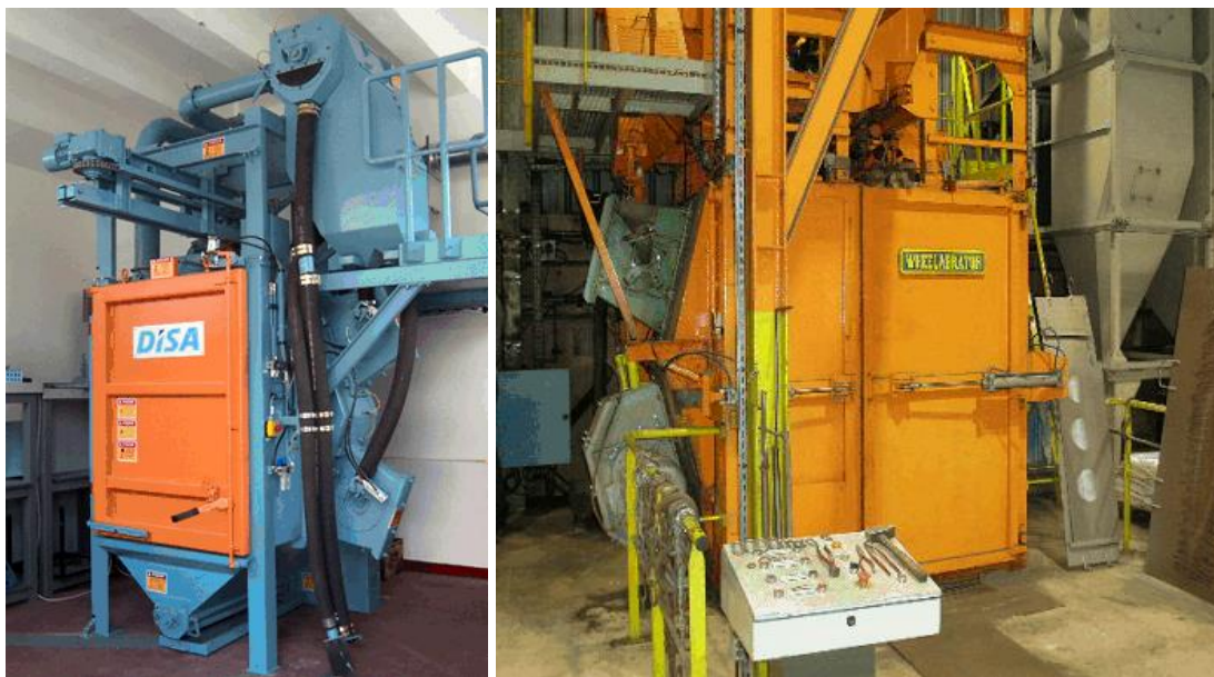
Obr. 38 Technické řešení stroje s metacímí koly (vlastní zpracování)
