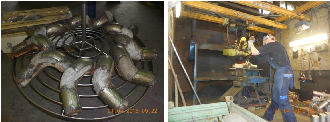
Obr. 17 Odlitky po pálení a řezání (vlastní zpracování)
