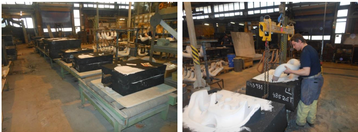
Obr. 15 Výroba formy (vlastní zpracování)
