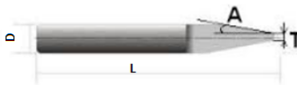
Obr. 6 Uhly rezného klina [2]
