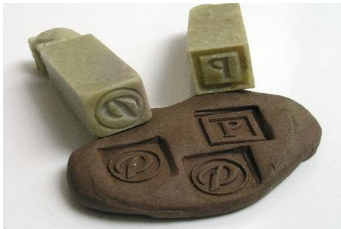
Obr. 40 3D Gravírovanie laserom, dutina obrázku [8]
