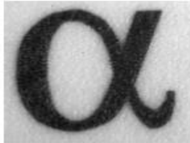
Obr. 36 Laserový popis karbonizácie [13]
