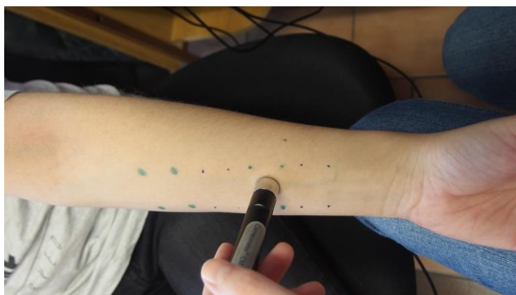
Obr. 14. Měření hydratace korneometrem CM 825 [vlastní zdroj]
