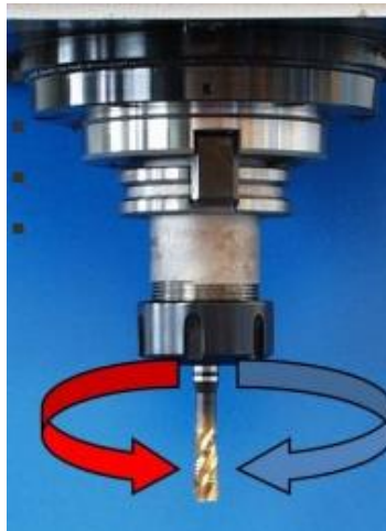
Obr. 12. Technologie Rigid tapping- závitování „na tvrdo“
