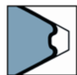
Nedostatečný profil v důsledku velkého průměru předvrtaného otvoru
