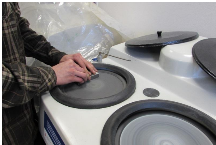
Obr. 34. Leštění vzorků před měřením tvrdosti
