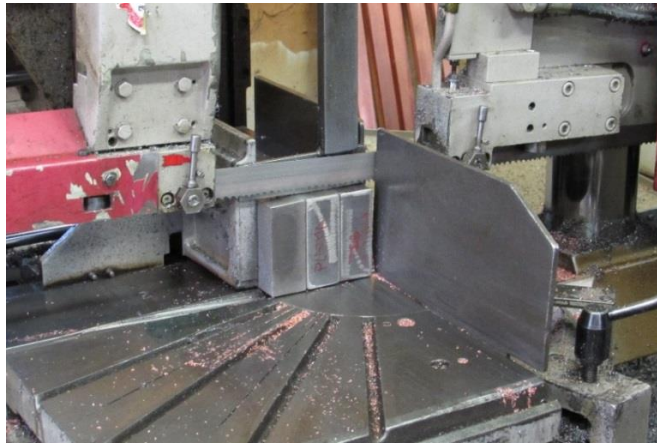
Obr. 33. Dělení vzorků na pásové pile
