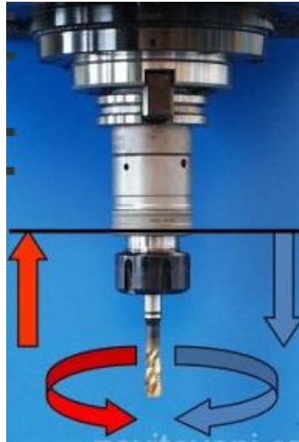
Obr. 13. Technologie závitování s vyrovnáním kroutícího momentu
