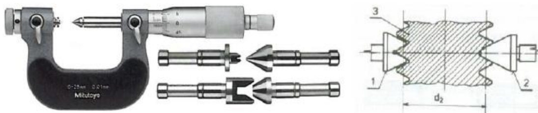
Obr. 24. Mikrometr s vyměnitelnými dotyky pro měření vnějších závitů [16]
