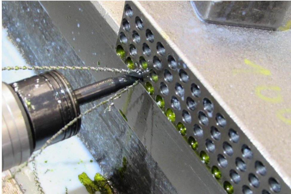
Obr. 39. Řezání závitů do tepelně ovlivněného povrchu
