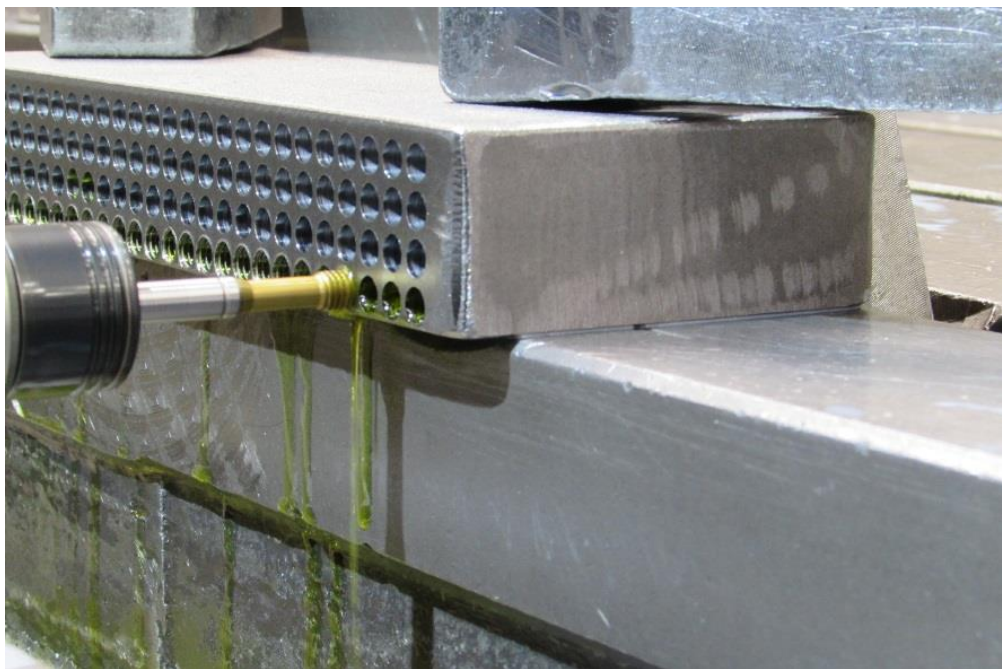
Obr. 40. Tváření závitů do tepelně ovlivněného povrchu
