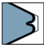
Správný profil při správném průměru předvrtané díry
