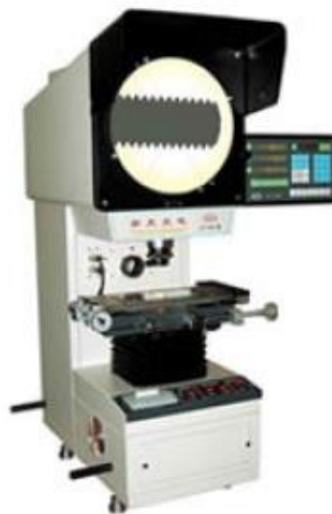
Obr. 26. Způsob měření závitů mikroskopem [11]
