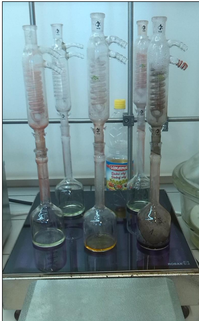
Obrázek 10: Mineralizace vzorků na topné desce
