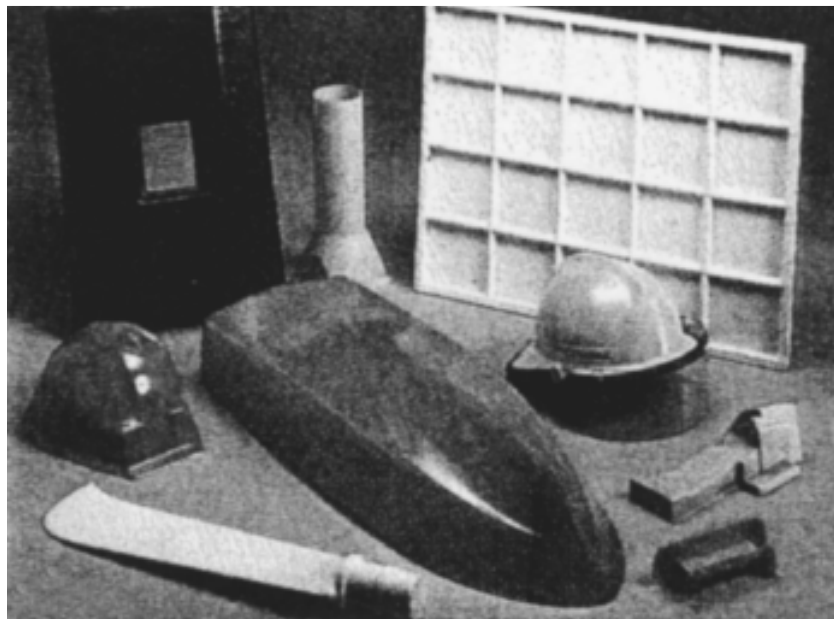
Obr. 30. Typické díly pro malé a střední série vyráběné RTM technologií. [4]
