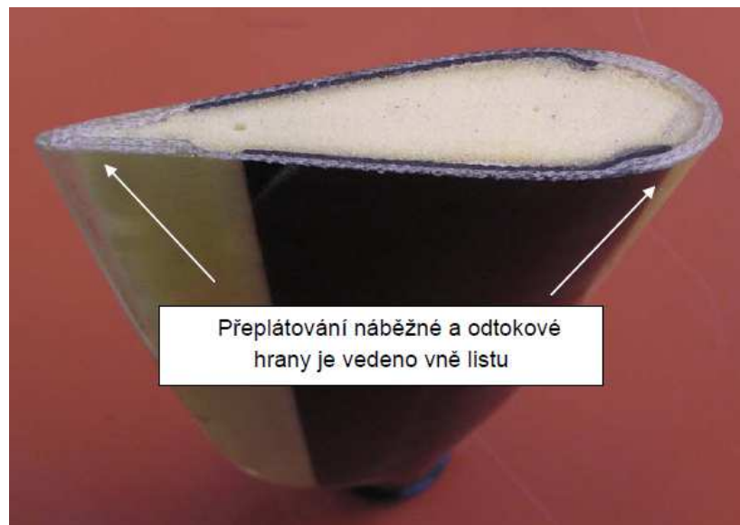
Obr. 24. Řez listem – viditelné je překrytí vrstev náběžné a odtokové hrany. [7]
