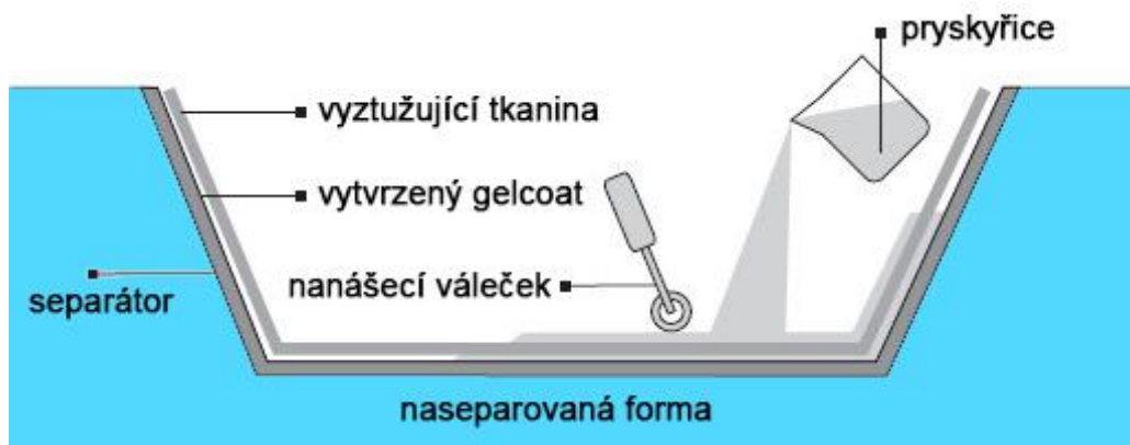
Obr. 10: Ukázka formy při ručním kladení prepregu [18]
