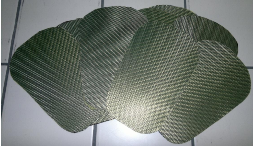
Obr. 62: Připravené nastřížené prepregy
