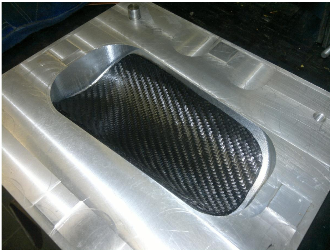
Obr. 66: Naskládané vrstvy prepregu na vytemperované formě
