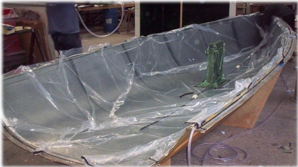
Obr. 18: Výroba kompozitního skeletu lodě vakuovou infuzí [28]
