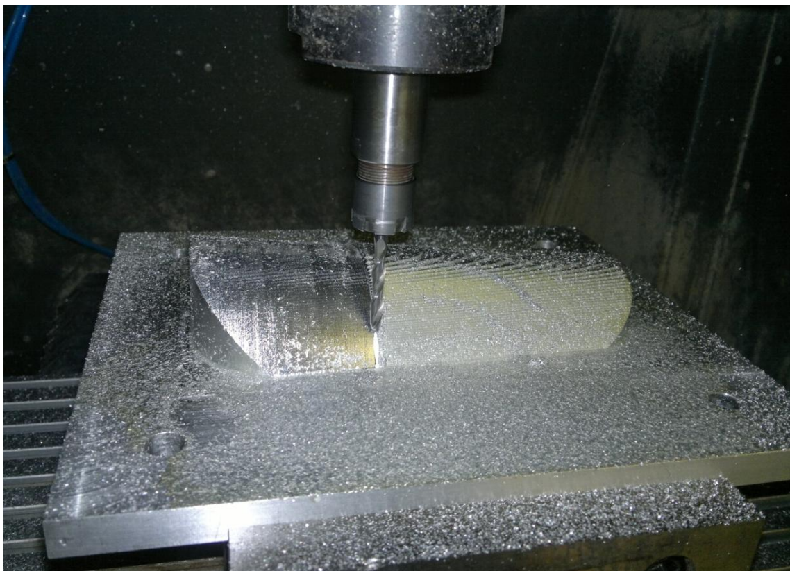
Obr. 54: Dokončení tvarové plochy tvárniku
