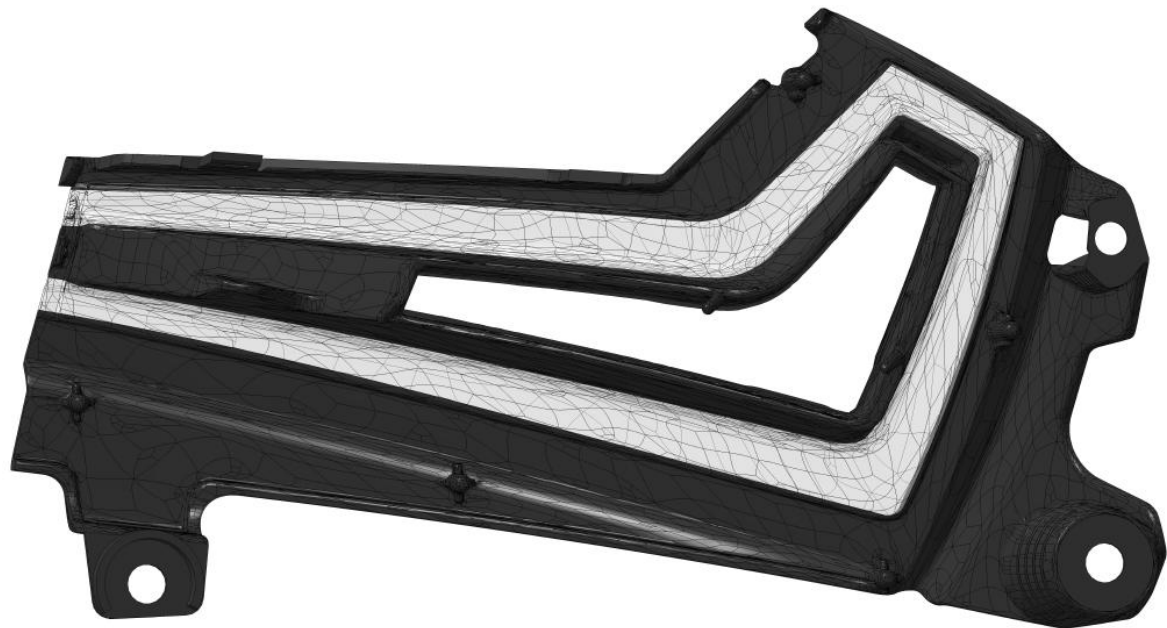
Obr. 28. Pohled ze zadní strany na vymodelovaný výrobek
