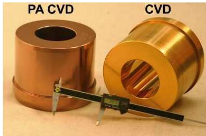
Obr. 23. Povlak PACVD splňuje lépe požadavky než původně využívaný CVD. [12]
