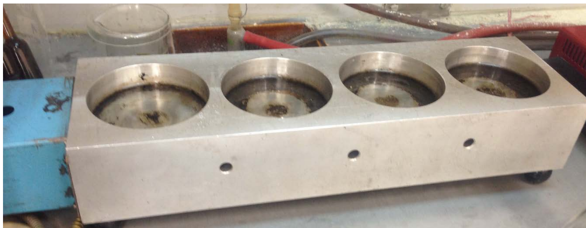
Obr. 37. Duralový vyhřívavý blok s termoregulací
