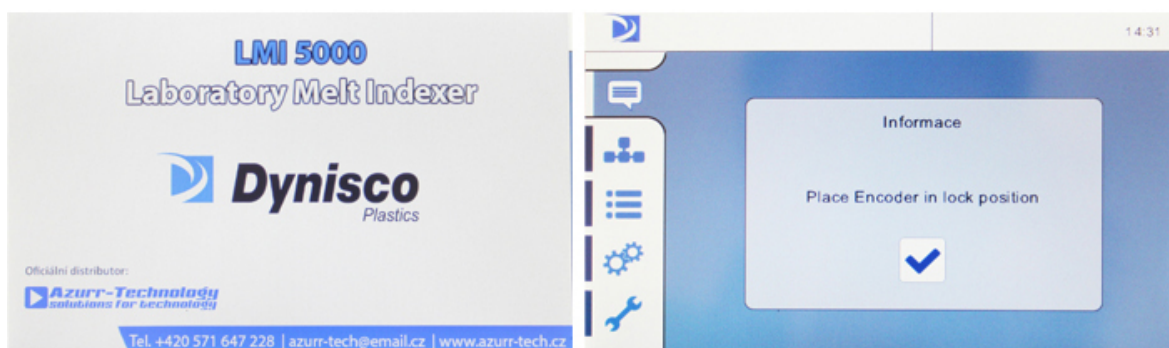
Obr. 42. Úvodní obrazovka s kalibrační hláškou enkodéru
