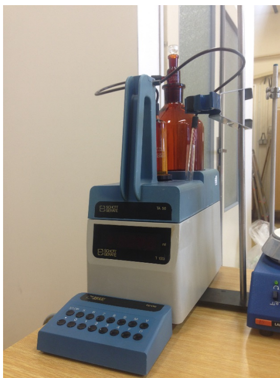
Obr. 36. Dávkovací zařízení s lahví rozpouštědla
