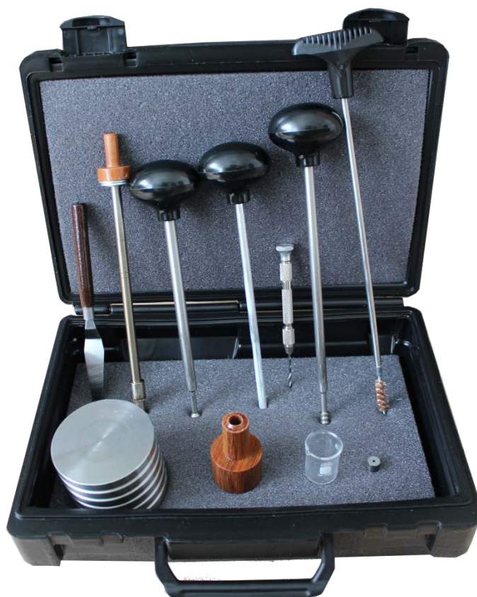
Obr. 41. Příslušenství pro měření s plastometrem
