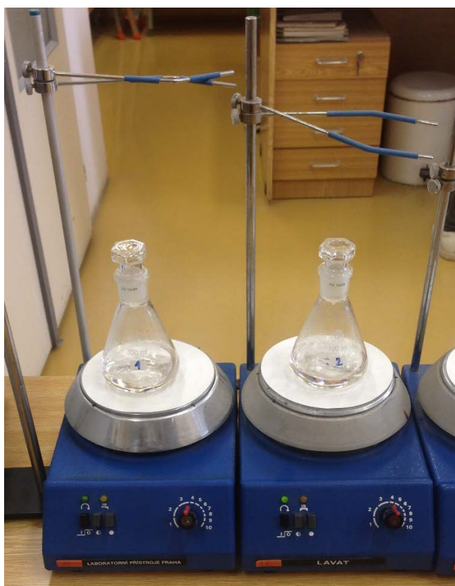
Obr. 38. Magnetická míchačka s kádinky obsahující vzorky PET
