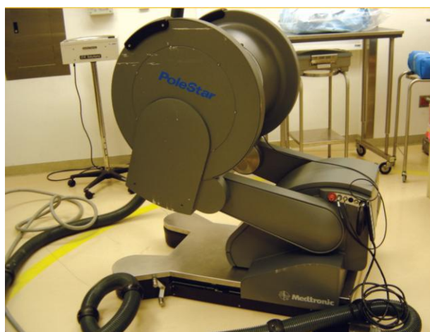
Obr. č. 10: Přenosný MR skener určený pro operační sál. [19]
