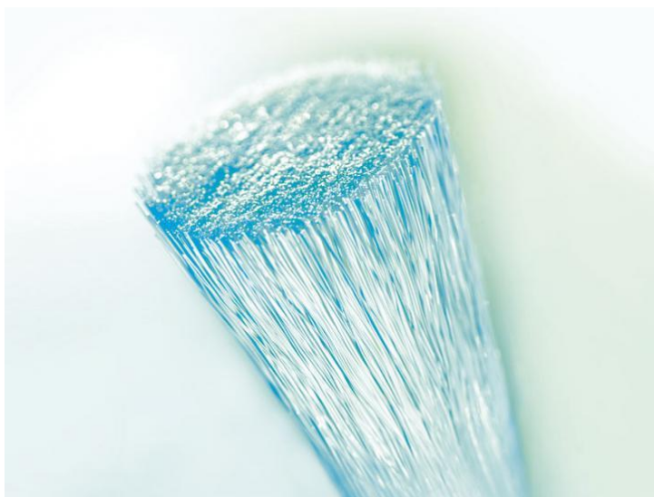
Obr. č. 13: Dialyzační membrána tvořená svazkem dutých polysulfonových vláken. [25]
