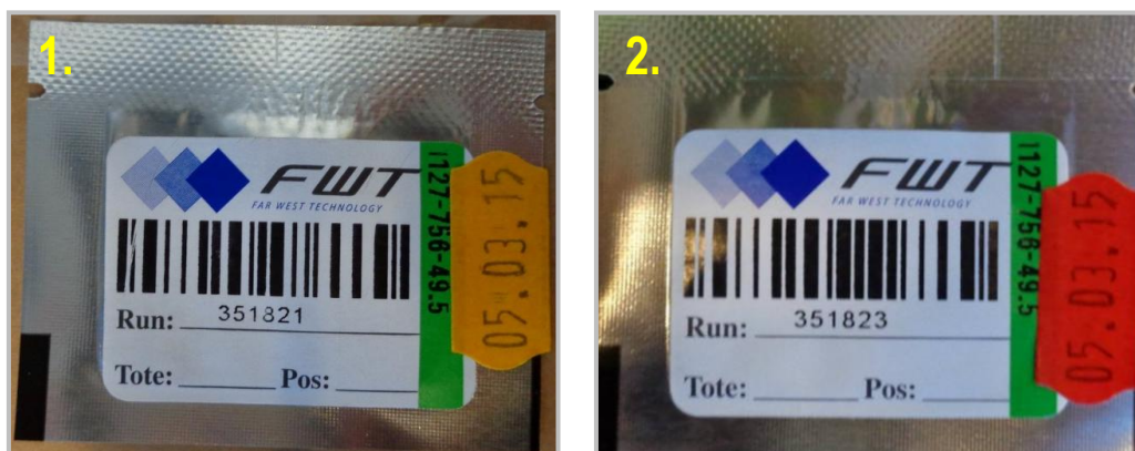
Obrázek 34: Pohled na dozimetr s identifikátorem (1 – před ozářením; 2 – po ozáření)
