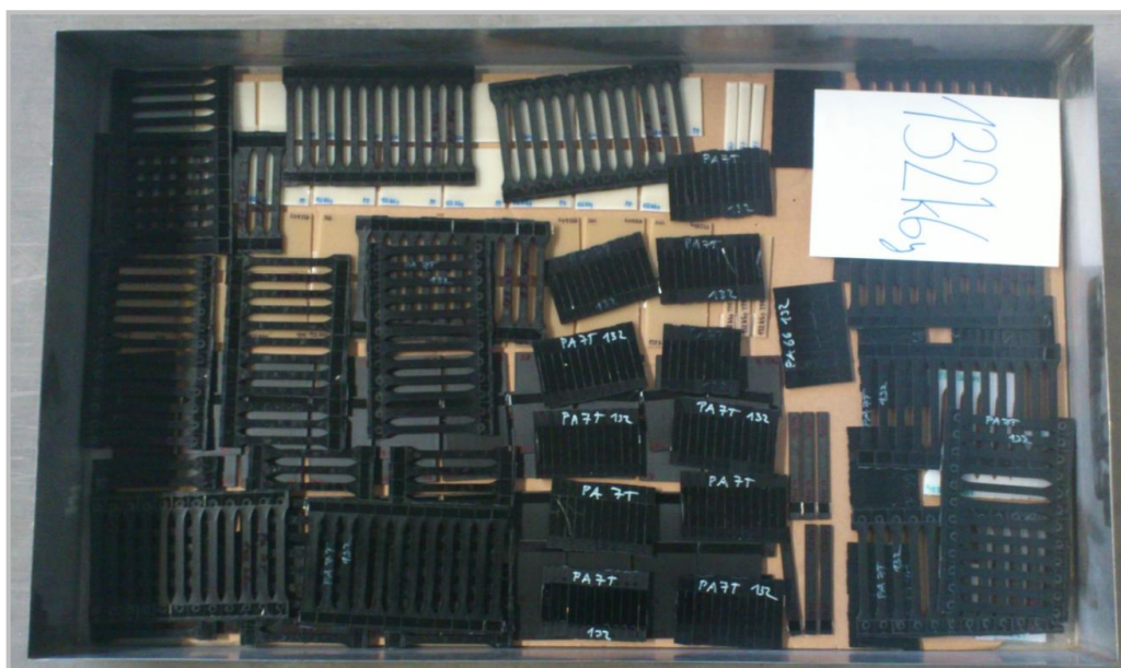
Obrázek 33: Připravená paleta se zkušebními tělesy určená pro dávku záření 132 kGy
