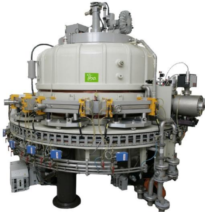
Obrázek 31: Elektronový urychlovač Rhodotron 10 MeV – 200 kW [47]
