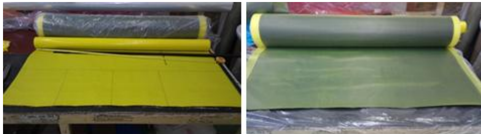
Obr. 49 Balík ze skelného (vlevo) a uhlíkového (vpravo) prepregu
