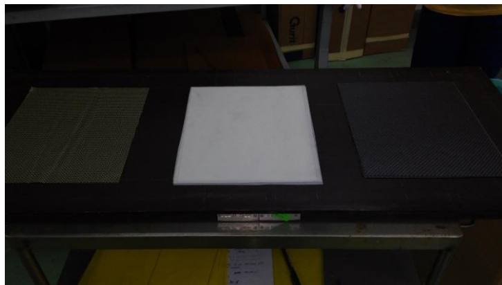
Obr. 51 Ruční kladení prepregu
