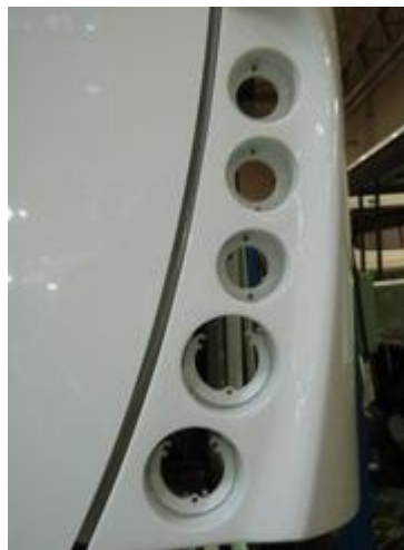
Obr. 7 Díl vyrobený RTM technologií [14]
