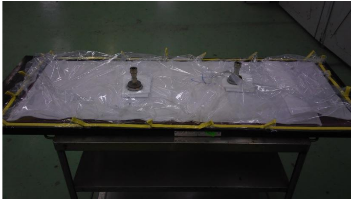
Obr. 55 Aplikace vakuovací folie
