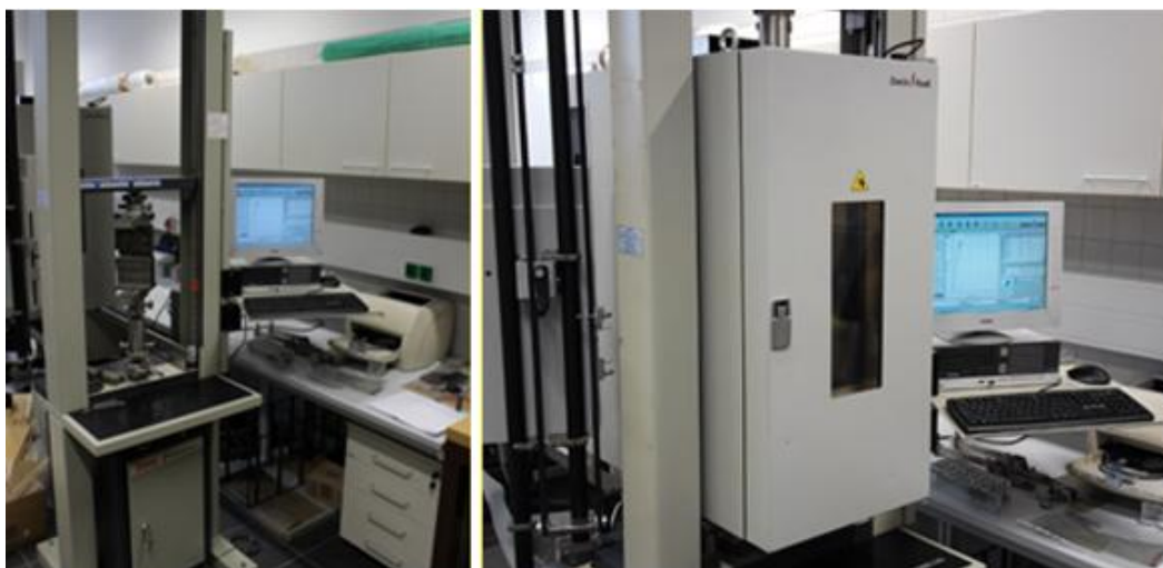
Obr. 59 Zwick 1456 (vlevo), teplotní komora Zwick 1456 (vpravo)
