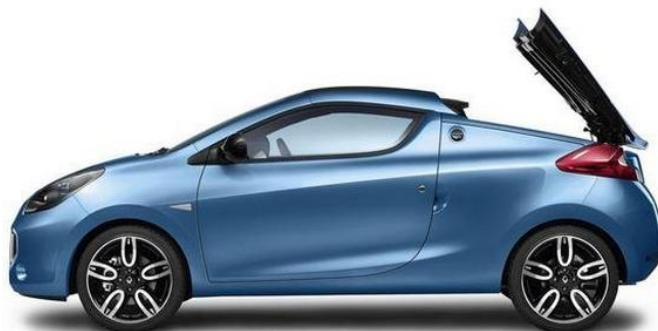
Obr. 20 SMC střecha u Renault Wind [24]
