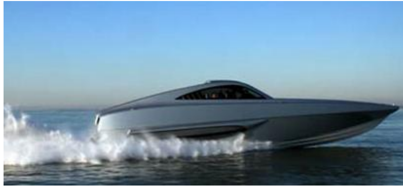
Obr. 3 Člun z uhlíkových a aramidových vláken [7]
