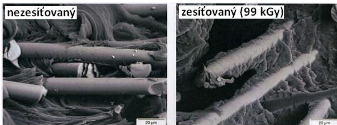
Obr. 17. Nezesítovaný a zesítovaný PA6-GF30. [36]
