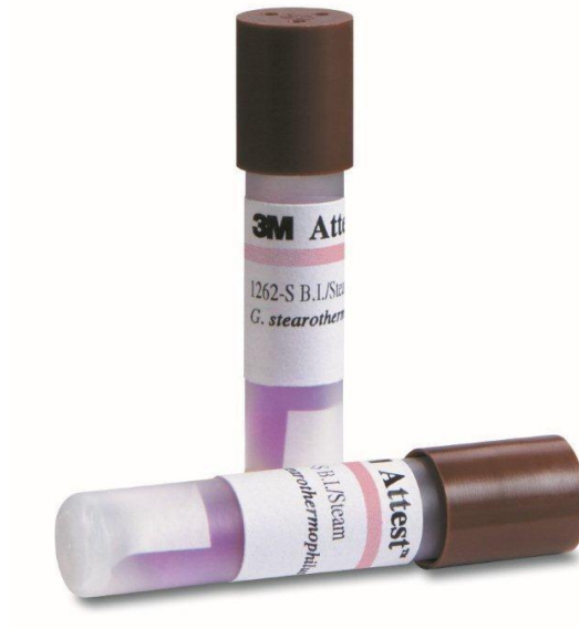
Obr. 2: Biologický indikátor s C. stearothermophilus [33]
