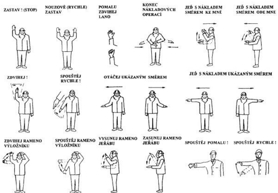
Obr. 3. Signalizace pro práci se zvedacím zařízením [11]
