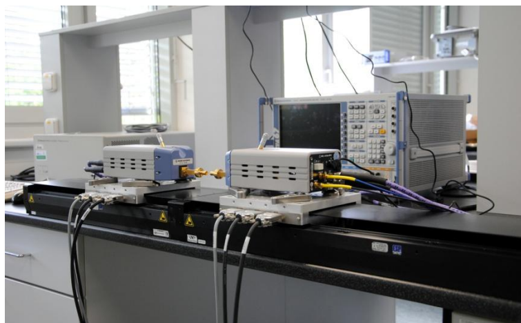
Obr. 33. Dráhy elektrických pojezdů s konvertory
