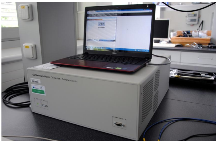
Obr. 34. Řídící jednotka pojezdů konvertorů
