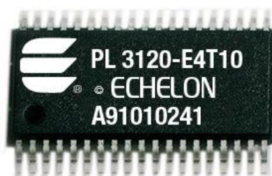
Obr. 32. Neuronový čip systému LonWorks [16]
