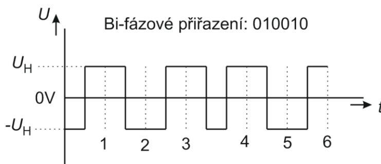
Obr. 14. Příklad Bi-fázového Manchesterského kódování
