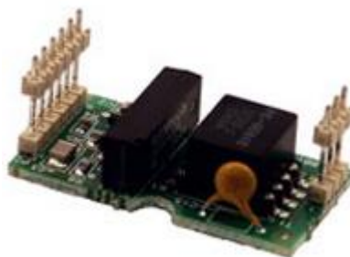
Obr. 33. Transceiver systému LonWorks pro kroucenou dvojlinku [16]
