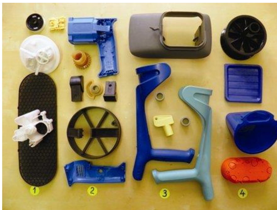
Obr. 2. Semikrystalické termoplasty: 1 – polyformaldehyd POM; 2 – polyamidy PA 6, PA 6,6; 3 – polypropylen a kopolymery PP; 4 – polyetyleny PE [6]
