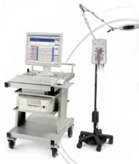
Obrázek 1 – ilustrační obrázek EEG. Základní systém je tvořen elektrodami, zesilovačem, počítačem s monitorem a stroboskopem. [18]
