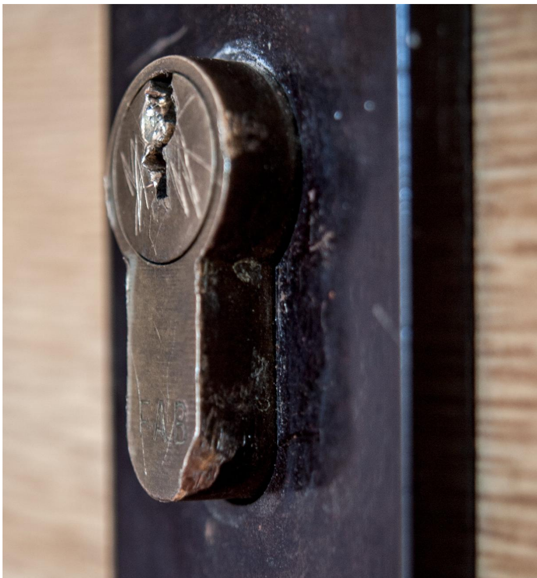
Obr. 24. Dynamické stopy po kleštích, pravá spodní část
