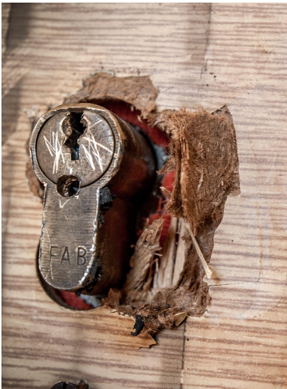
Obr. 29. Stopa barvy na cylindrické vložce
