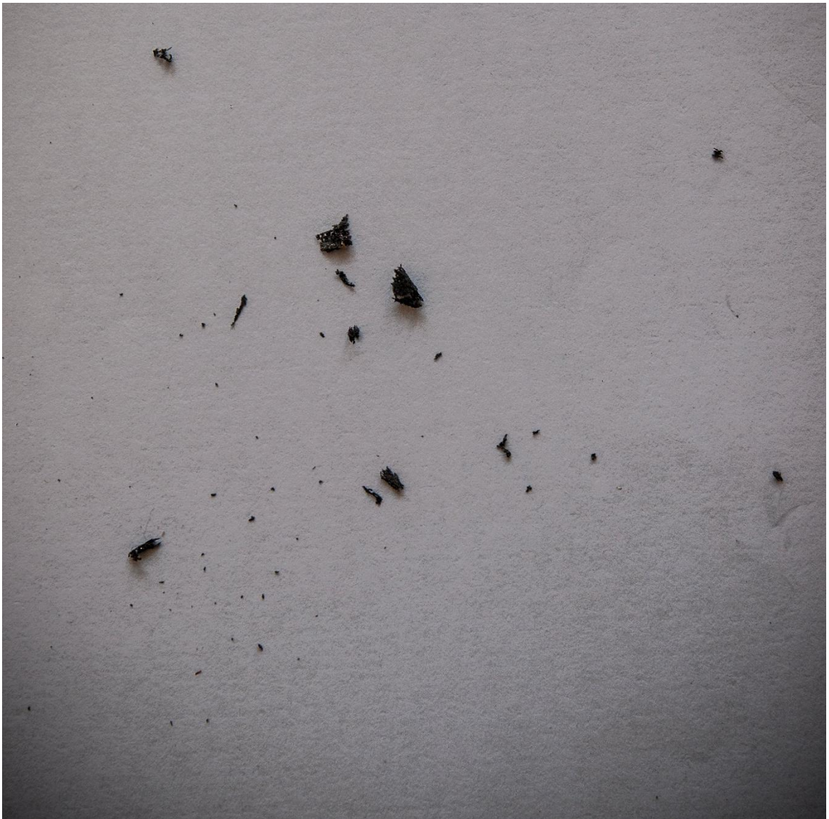
Obr. 31. Stopy barvy oddělené od cylindrické vložky
