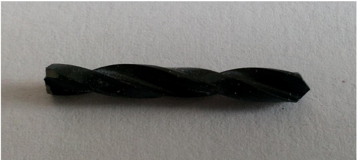
Obr. 27. Vrták zalomený při pokusu o odvrtání
