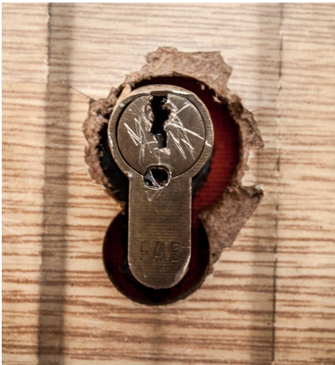
Obr. 26. Typická stopa vrtání na čelní straně zámku
