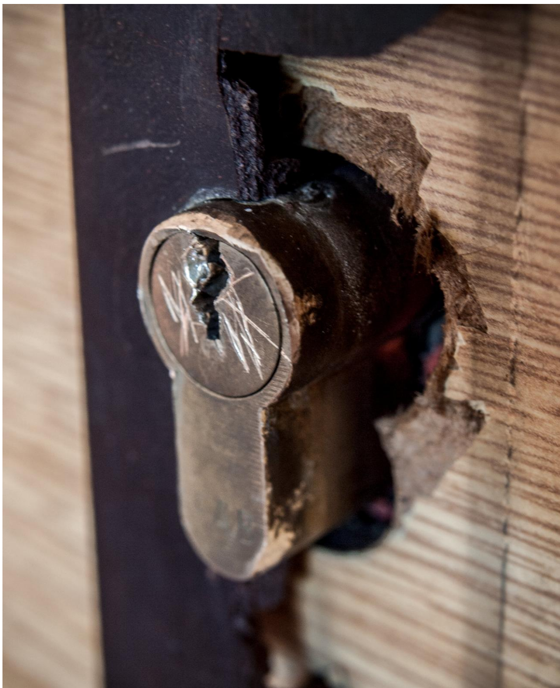
Obr. 25. Vtisky na horní části zámku po opakovaném úderu kladivem
