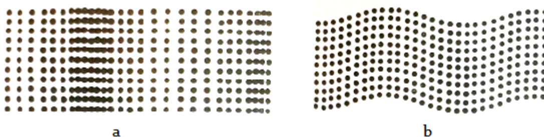
Obr. 3. Kmitání částic prostředí při šíření vlny [1]
