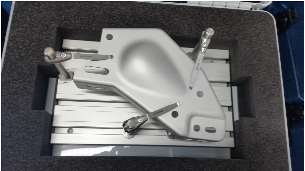
Obrázek 10. Měřidlo měřené na souřadnicovém měřicím stroji FARO
