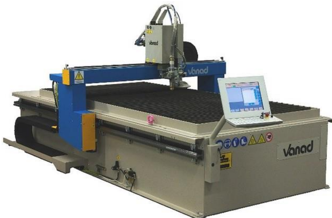
Obr. 4 Plazmový řezací stůl [13]
