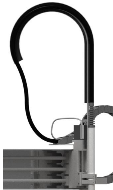
Obr. 28 Řez hadicí vedení osa Z
