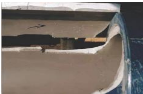
Obr. 11. Trhlina ve výlisku z ABS [17].
