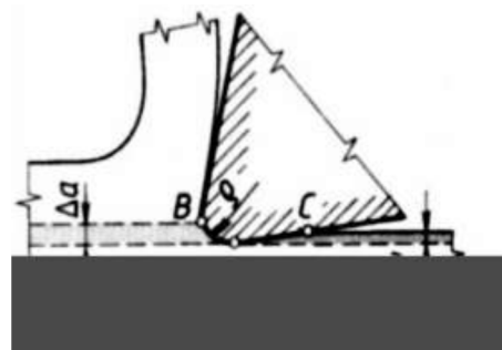
Obrázek 22: Znázornění vzniku stlačeného pásma v povrchové vrstvě [12]
