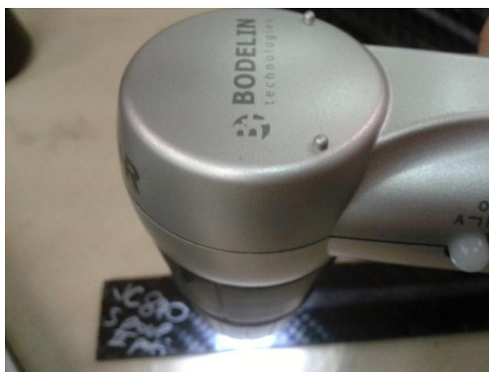
Obr. 65. Snímání povrchu ručním mikroskopem ProScope HR
