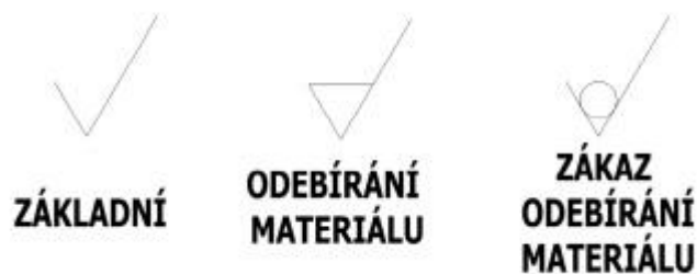
Obr. 40. Základní druhy označení pro drsnost povrchu [23]
