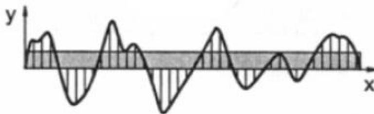
Obr. 37. Průměrná aritmetická úchylka posuzovaného profilu R_a (šedivě) [23]
