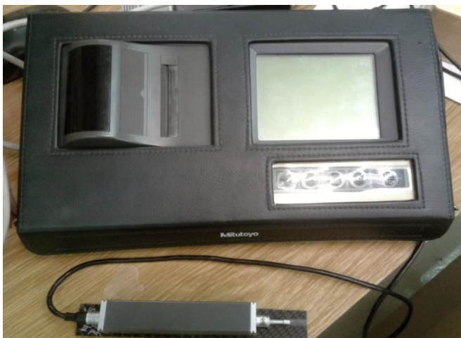
Obr. 62. Drsnoměr Mitutoyo Surftest SJ 301
