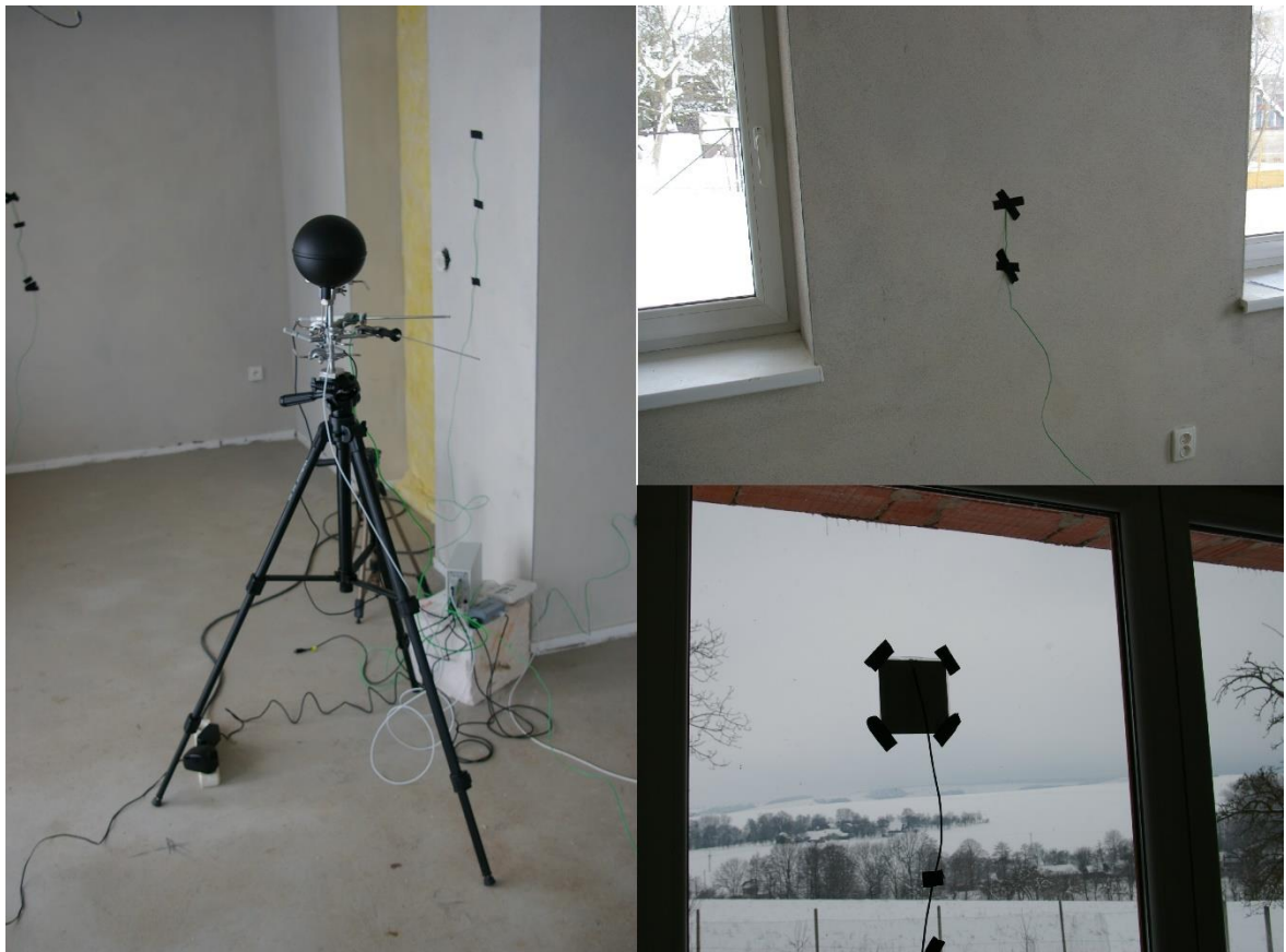
Obr. 17. Umiestnenie snímačov – vľavo umiestnenie na statíve, vpravo hore snímanie povrchovej teploty, vpravo dole umiestnenie snímača tepelného toku na okne
