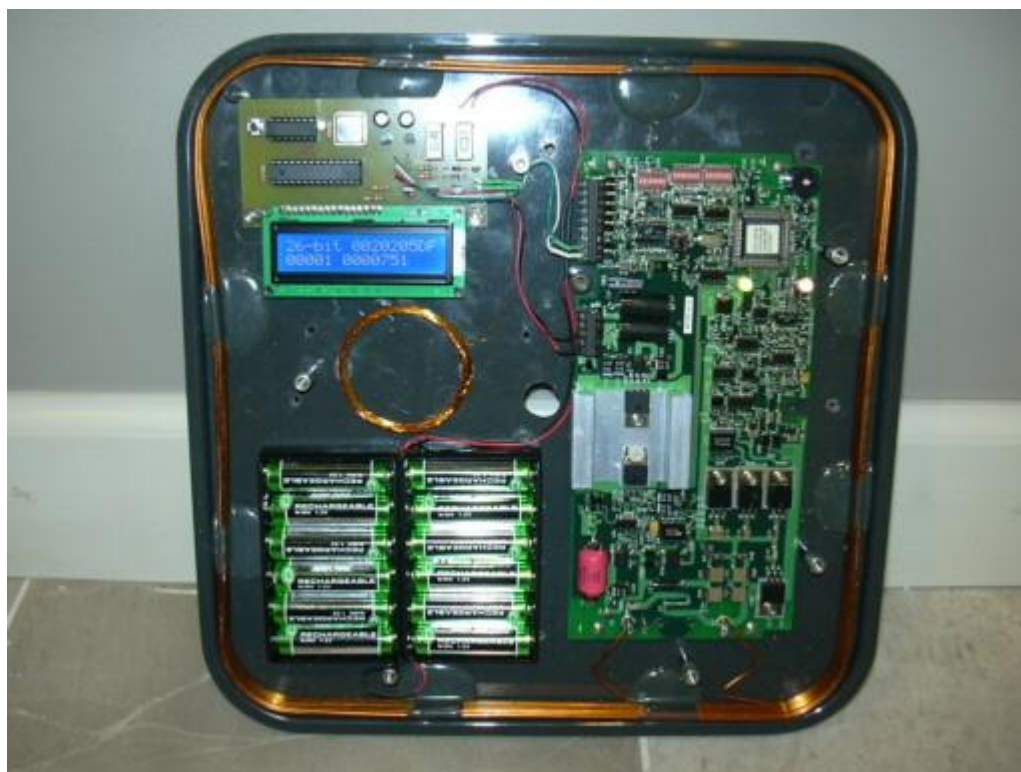
Obr. 14. Mobilní kopírovací čtečka s dlouhým dosahem, zdroj: http://www.proxclone.com
