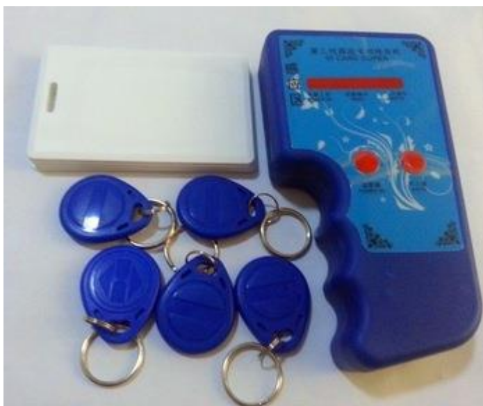
Obr. 13. Kopírovací zařízení EM marin karet, zdroj:
