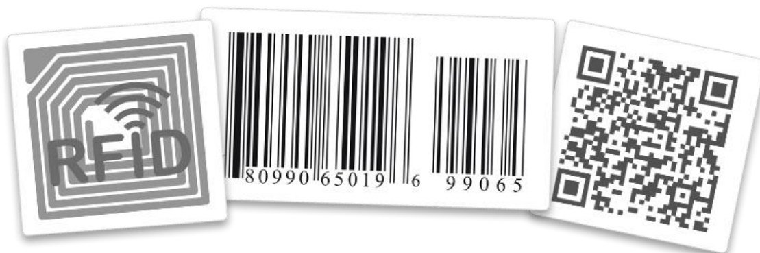
Obr. 1. Porovnání RFID čipu, čárového kódu a QR kódu, zdroj: http://www.inspectall.com
