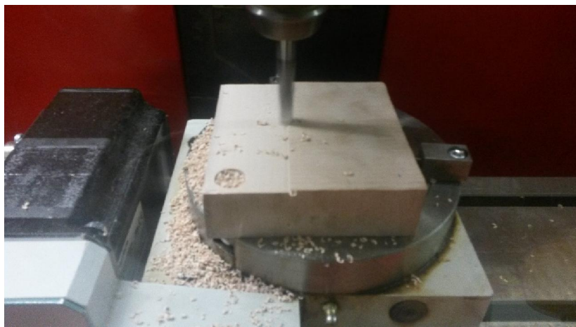
Obr. 56 Srovnání čela, první operace
