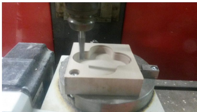
Obr. 58 Dokončení stěn, třetí operace
