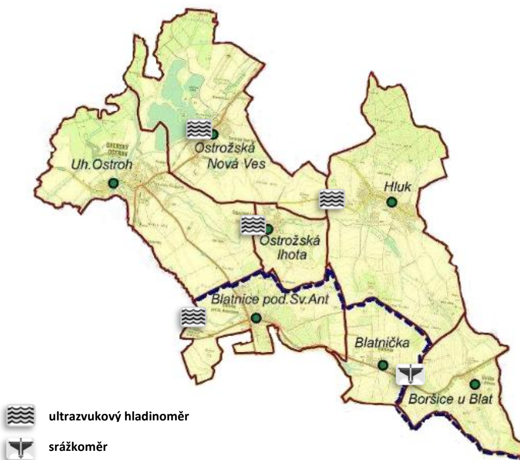
Obrázek 2 Rozmístění ultrazvukových hladinoměrů a srážkoměrů v Mikroregionu Ostrožsko [18] [vlastní zpracování]
