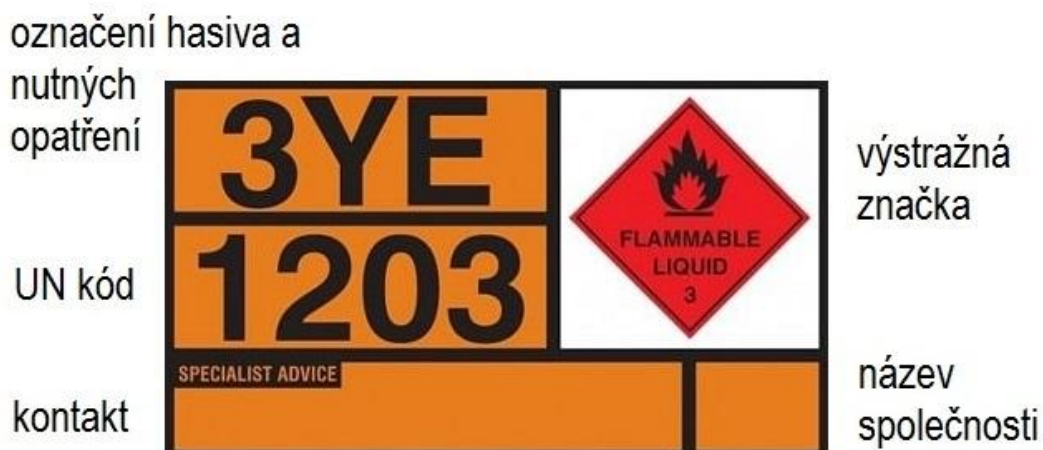
Obrázek 3: Popis systému Hazchem [zdroj: vlastní]
