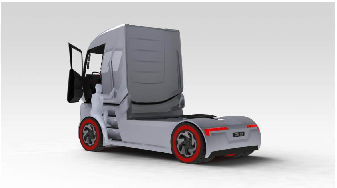
Obr. 46. Studie nastupování do kabiny vozidla č.2
