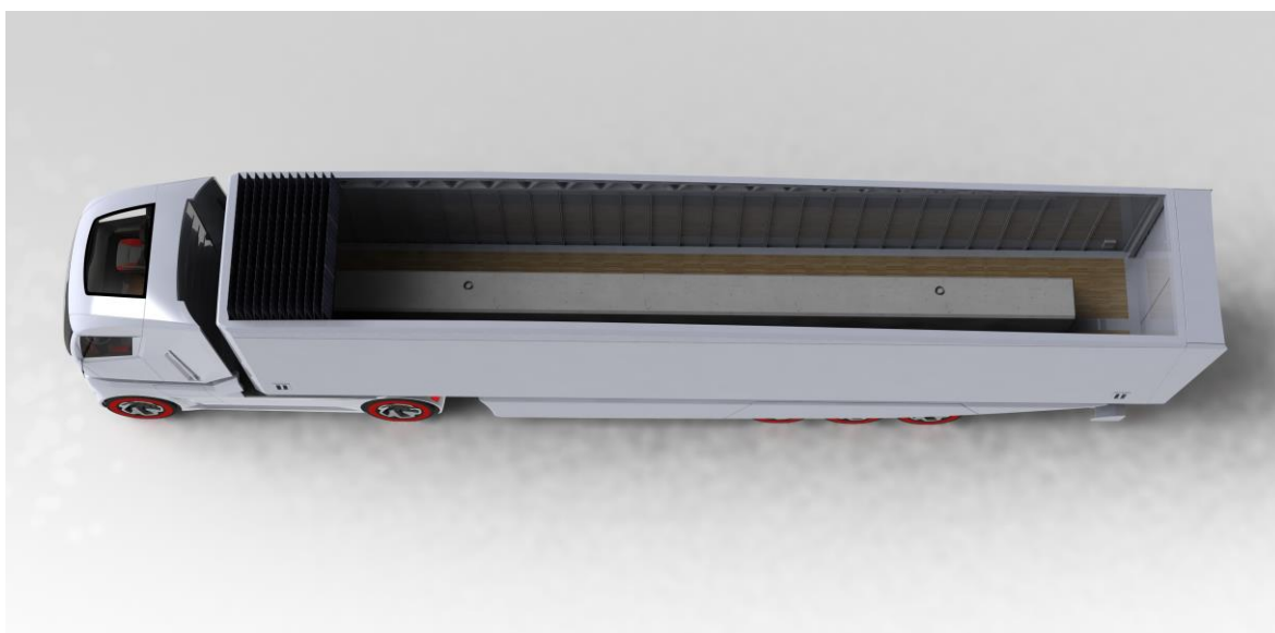
Obr. 56. Vůz ONYX s (nezajištěným) železobetonovým stavebním nosíkem o hmot. 23 tun
