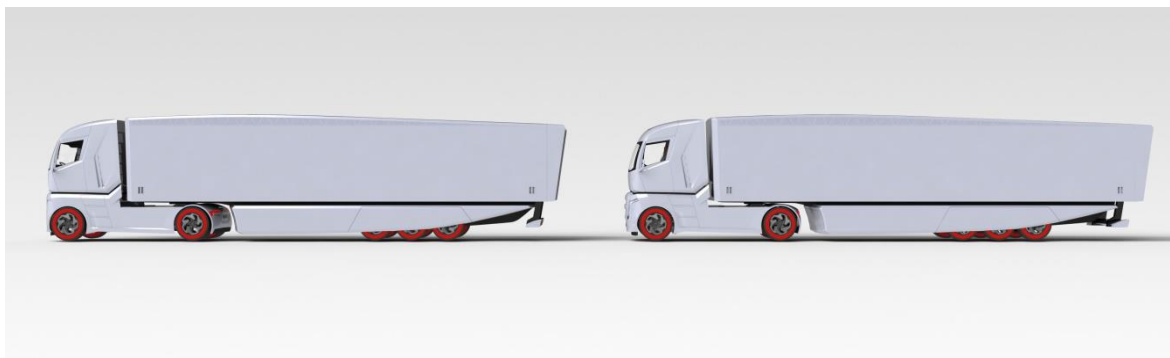
Obr. 59. Spojitá jízdní souprava, sekundární vůz je v autonomním režimu jízdy
