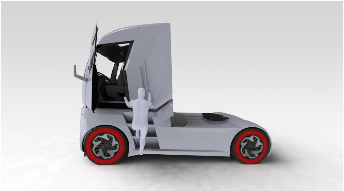
Obr. 45. Studie nastupování do kabiny vozidla č.1
