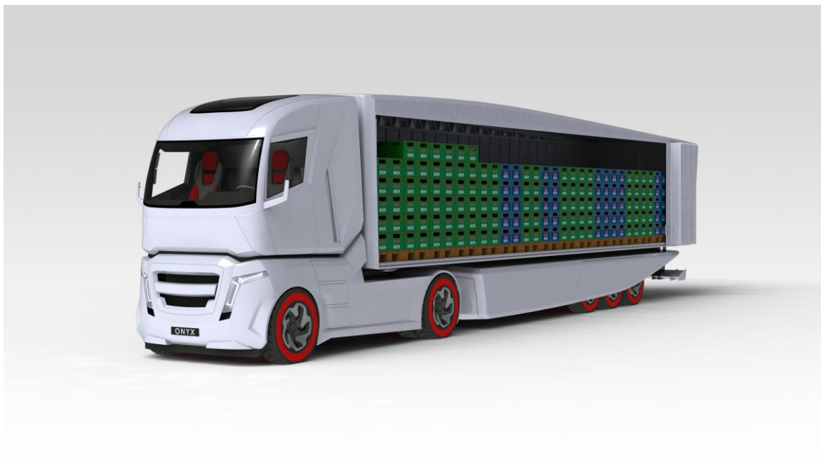
Obr. 55. Vůz ONYX s nákladem plných pивních přepravek o hmotnosti 25,5 tun
